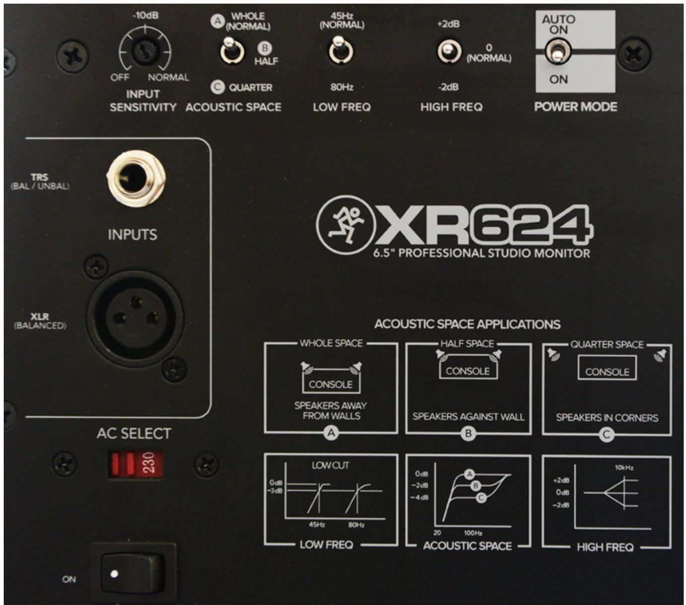
Über drei weitere Kippschalter lässt sich die Box an ihre Umgebung akustisch anpassen. Über den Schalter "Acoustic Space" werden drei Filterkurven aktiviert, die sich im Mittenbereich unterscheiden, optimiert auf den jeweiligen Aufstellungsort (auf der Konsole im Raum, an der Konsole an der Wand oder neben der Konsole in den Ecken des Raums). Weiter lässt sich der Low Cut über einen
