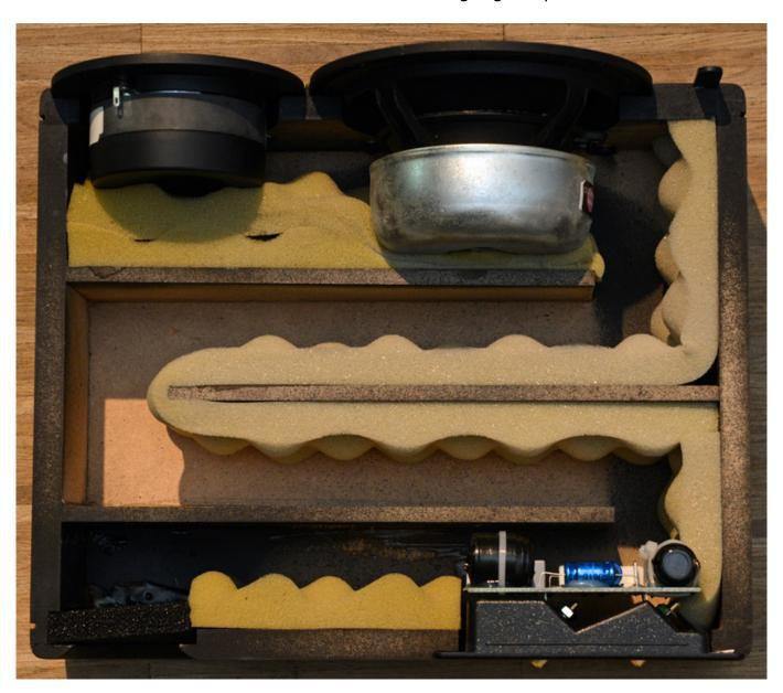
Befindet sich die Lautsprechermembrane bei einem Transmission-Line-Lautsprecher in der Ruhelage so wird über die Transmission Line Schallenergie an den Raum
