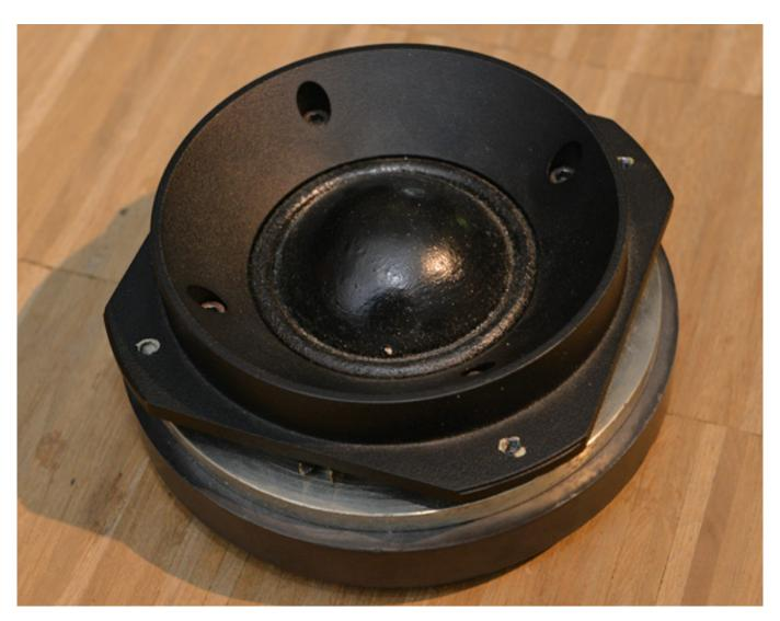
Die Übergangsfrequenzen des Dreiwege-Systems liegen bei 380 Hz sowie 3,8 kHz. Die Crossover-Filter haben eine Steilheit von 24 dB/Oktave. Für den Mittentonbereich kommt ein eigener 75-mm Soft-Dome-Treiber zum Einsatz (s. Abb. oben), der auch im Hause von PMC handgefertigt wird. Die Fertigung des Treibers nimmt ungefähr eine Woche in Anspruch. Zudem werden die Treiber in einem Setup noch selektiert.
