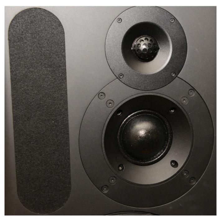
Im Vergleich zu der MB2 sieht man, dass die Mittelton- und der Hochtontreiber bei der MB3 leicht versetzt angeordnet sind um unter anderem für eine bessere Stereo- und Mittenortung zu sorgen.
