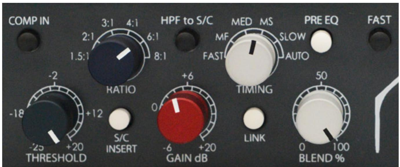
Der Kompressor ist ein Diodenbrückenkompressor. Dieses Funktionsprinzip wurde schon bei dem legendären 2254 genutzt. Der Kompressor im RND Shelford Channel ist aber eine Neuentwicklung. Der Kompressor ist mittels eines Schalters im Signalweg vor dem EQ platzierbar. Auch diese Sektion wird mittels eines beleuchteten Schalters aktiviert, die Schalter für Link, Sidechain und PreEQ sind
