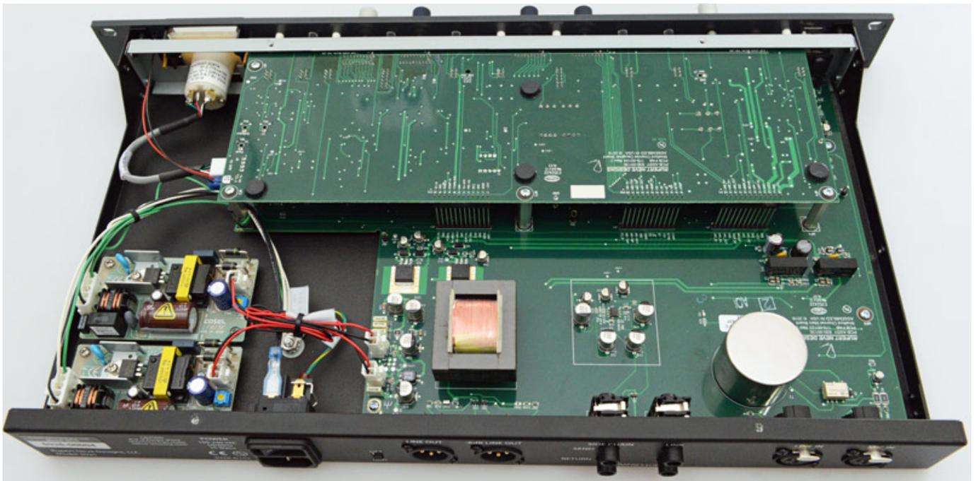
Relativ viel Aufwand hat RND mit der Stromversorgung betrieben. Hinter die zwei Schaltnetzteile für die positive und negative 24-V-Versorgung wurde noch eine auf LM 317/LM 337 basierende Regelung implementiert. Die 48 Volt für die Phantomspeisung wird mit zwei 24 Volt DC-DC-Konvertern erzeugt.
