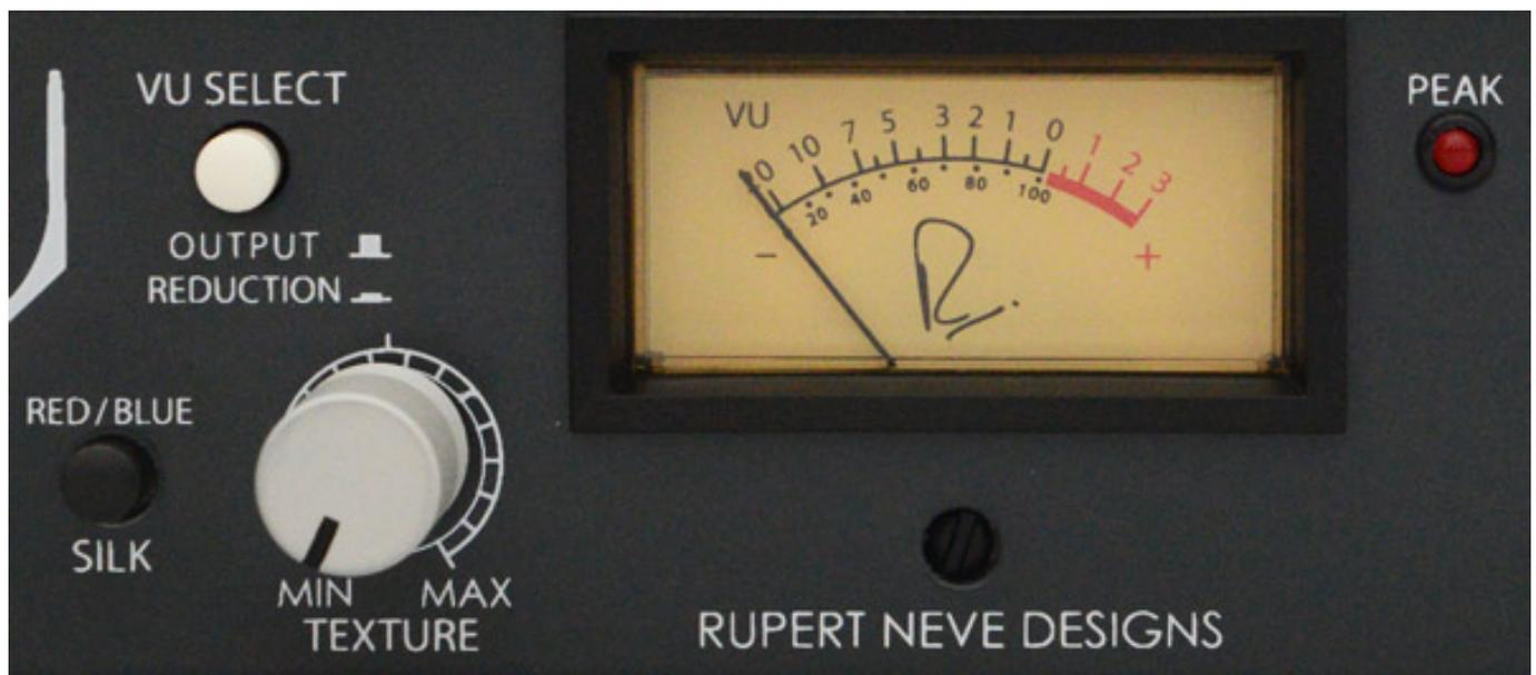
Bei der Meter-Sektion mit Texture-Poti sieht man, dass die Frontplattenbedruckung um das Poti einen Versatz zur Potiachse aufweist. Diesen Versatz findet man in
