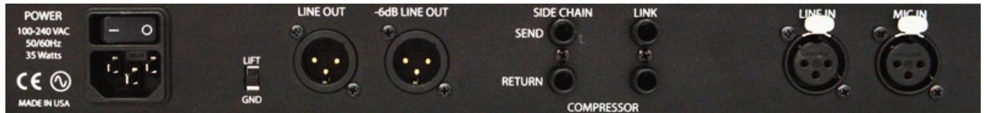
Rückseitig befinden sich die XLR-Buchsen für den Line- und den Mikrofon-Eingang, Da neben gibt es zwei 6,3-mm-Klinkenbuchsen für den Kompressor-Side-Chain (Send/Return) sowie zwei Buchsen für die Verkoppelung zweier Shelford-Channel.
