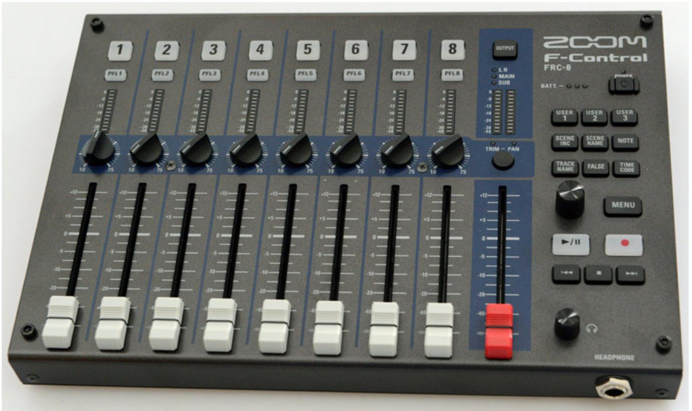
Die Bedienoberfläche bietet acht Kanalzüge sowie ein Master-Kanalzug mit 60-mm-Fader. In den Kanalzügen befinden sich je ein Bargraf-Pegelmeter (12 LEDs), Taster für Kanal Play/Record (je nach Betriebsart) mit integrierter zweifarbigem LED sowie ein Taster für PFL-Funktion und den Kanaldrehgeber für Gain oder Panorama. Welche Funktion er bei der F-Control übernimmt wird mit einem Taster im Summenkanalzug bestimmt. Über zwei LEDs wird die angewählte Funktion signalisiert.
