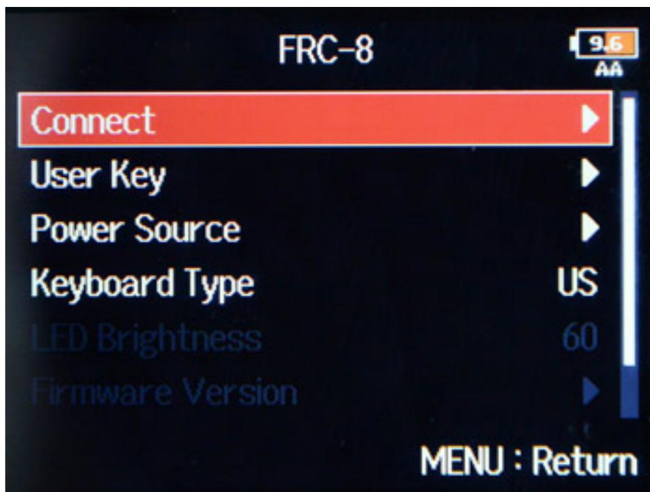
Über den ersten Menüpunkt kann man eine Verbindung zur F-Control initiieren. Wenn die Verbindung hergestellt ist erscheinen weitere Menüpunkte (s. Abb. unten).
