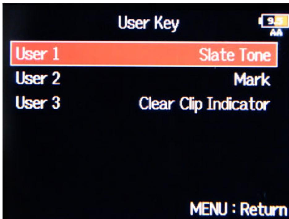
Zurzeit gibt es folgende Zuordnungen: Slate-Mikrofon, Slate Tone, Marker setzen (während Aufnahme und auch der Wiedergabe), öffne Trim-Link-Dialog, Tastensperre (Key Hold Target), lösche Meter-Clips und Wiedergabeschleife des aktuellen Takes. Ab Werk sind die drei User-Tastenden den Funktionen Slate Tone ausgeben, Marker setzen und Meter-Clip-Indikator zurücksetzen, zugewiesen.
