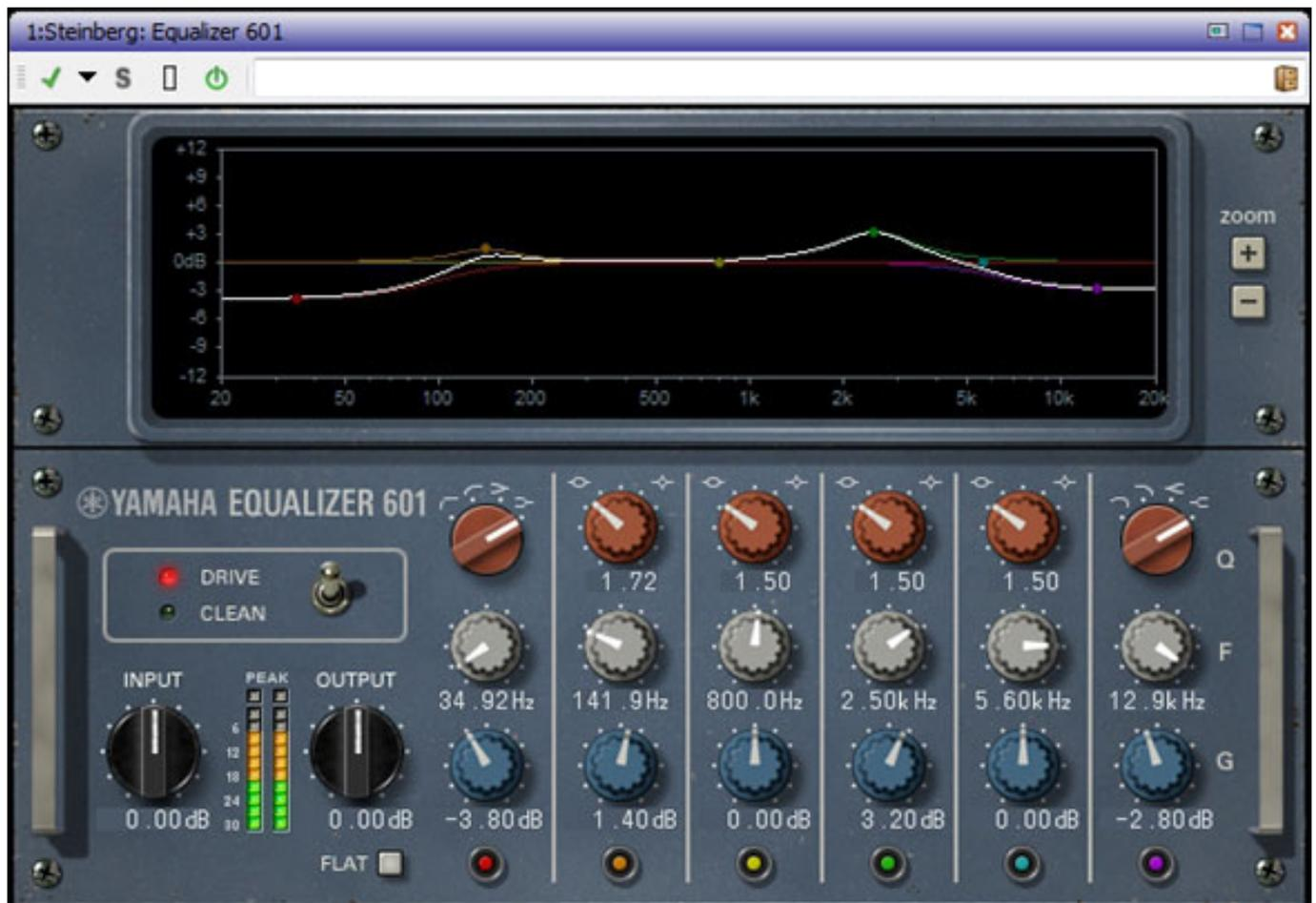
Es gibt z. B. die Möglichkeit die Ansteuerung und die damit u. U. verbundenen Verzerrungsprodukte zu kontrollieren, in dem man zwischen der Betriebsart "Drive" und "Clean" umschaltet. Die Darstellung oben zeigt nicht nur die Filterkurve (resultierende und einzelne Filterbänder) an sondern gestattet auch mit der Maus Frequenzen und Gain zu beeinflussen. Auch die Filtergüte, bzw. die Steilheit lässt
