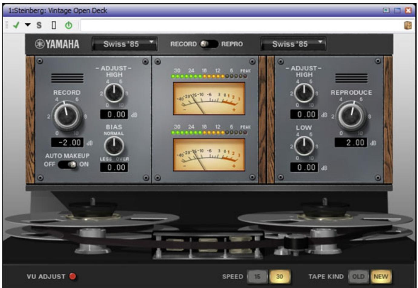
Neben den üblichen Parametern wie Bass- und Höhenentzerrung kann auch die Vormagnetisierung (Bias) und natürlich Aufnahme- (Record) und Wiedergabepegel (Reproduce) beeinflusst werden. Weiter lässt sich die Bandgeschwindigkeit in zwei Stufen (15/30 Inch/Sek.) sowie die Bandsorte (Old/New) verändern. Neben der Simulation der VU-Meter gibt es auch noch eine Bargraf-Pegelanzeige.
