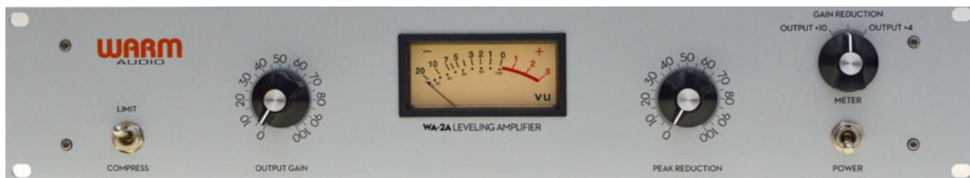
Im Gegensatz zum 3 HE-Original ist der WA-2A nur 2 HE hoch. Das Gehäuse ist mit Lüftungsschlitzen versehen. Warm Audio bittet über ein Hinweis auf dem Deckel um ausreichend Leerplatz über dem Gerät, da sonst die Gefahr eines Wärmestaus besteht. Während der Testphase war die Wärmeentwicklung freistehend recht moderat.
