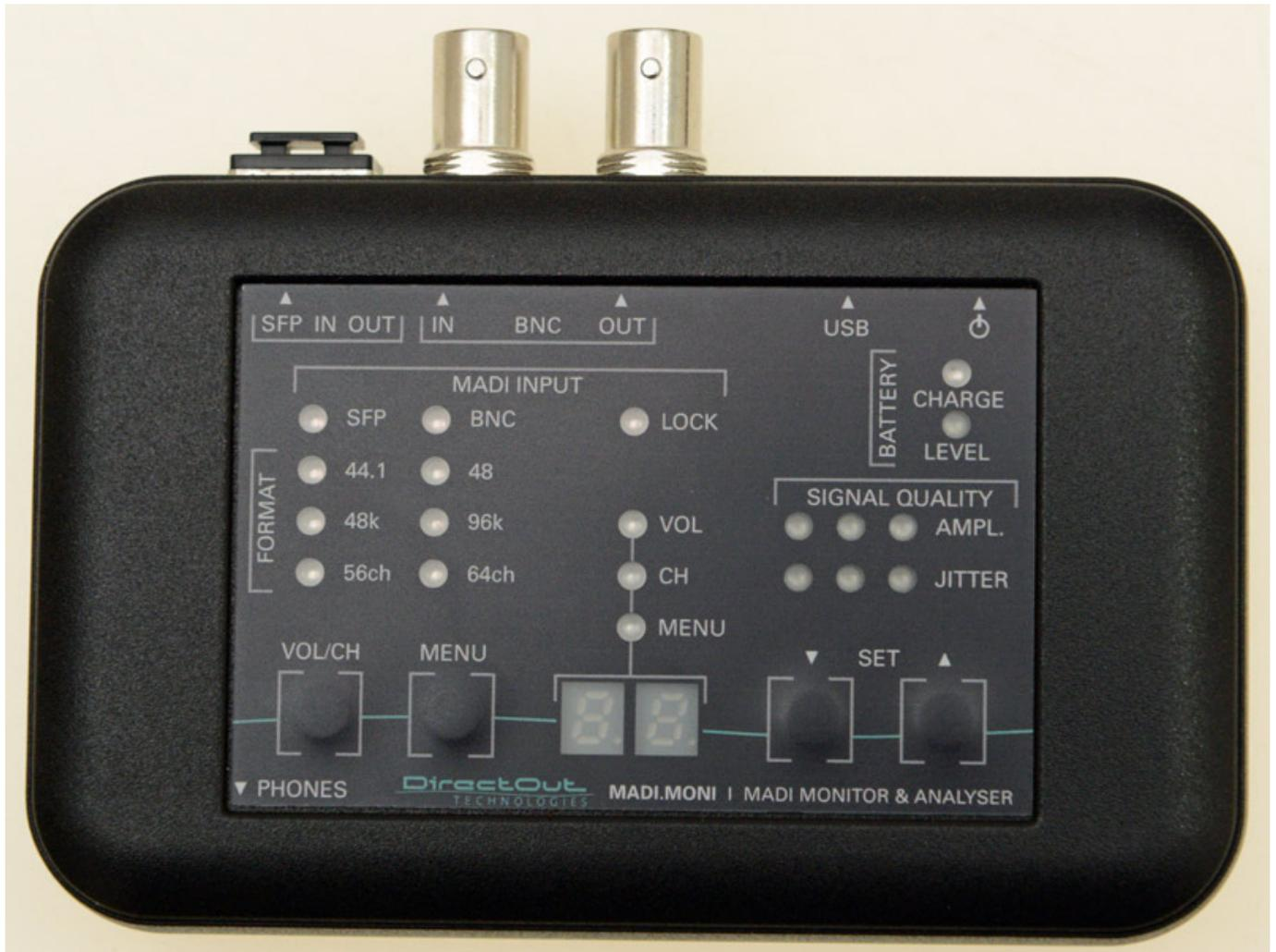
Der MADI.MONI ist ein Analyzer mit Monitoring-Funktion, den man in den Signalweg einschleift. Er wiegt 200 Gramm und ist 120 mm breit, 90 mm tief und 28 mm hoch.
