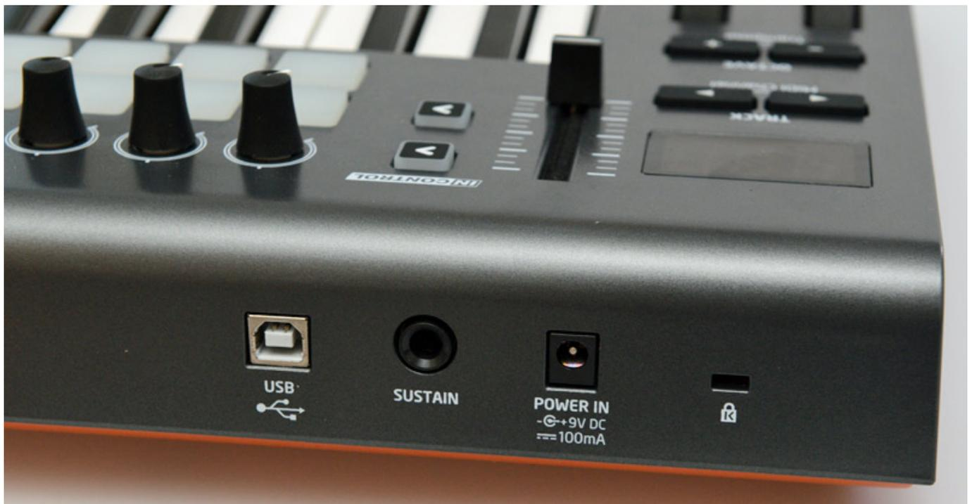
Die Spannungsversorgung kann sowohl über USB als auch über ein externes Netzteil erfolgen. Wie das Launchkey Mini hat auch das große Schwestermodell einen Anschluss für eine Kensington-Sicherung. Weiter bietet es auch noch über eine Klinkenbuchse den Anschluss eines Sustain-Pedals.
