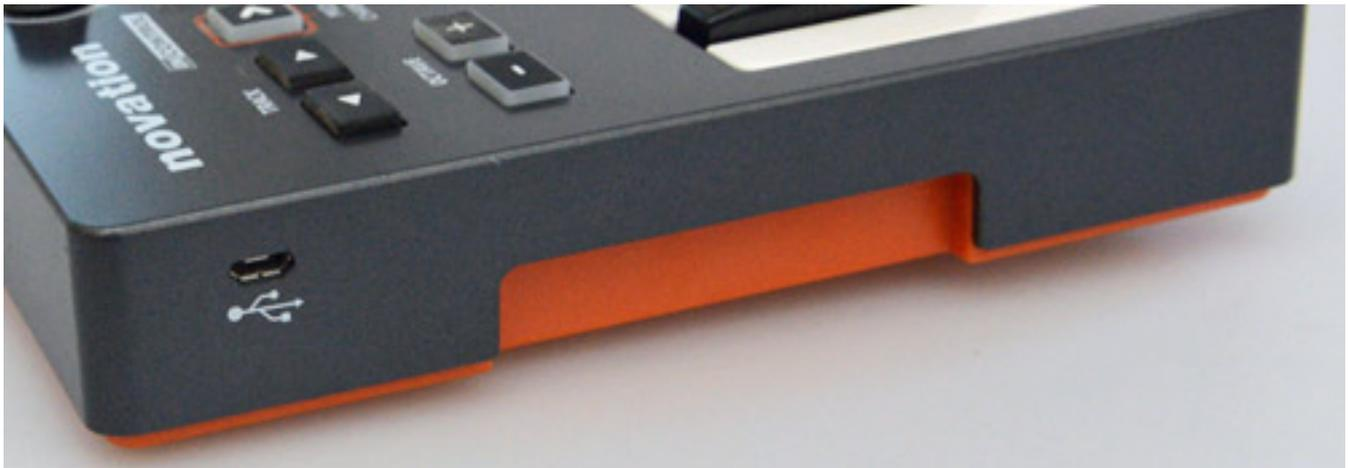
Das Launchkey Mini ist class compliant und daher müssen kein Treiber installiert werden. Die USB-Mikro-B-Buchse befindet sich links an der Seite des Keyboards. Auch mit Betriebsspannung wird das Keyboard via USB versorgt. Über das Camera Connection Kit lässt sich das Launchkey Mini auch an einem iPad anschließen.
