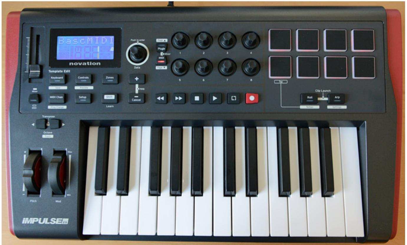
Nun zum Impulse 25 von Novation. Wie das Novation Launchkey wir auch das Impuls MKII in Versionen mit 49 oder 61 Tasten von Novation angeboten. Auch hier gibt es dann mehr Fader und die zusätzlichen Funktionstasten unter den Fadern. Die Tasten sind über Gewichte halbgewichtet.
