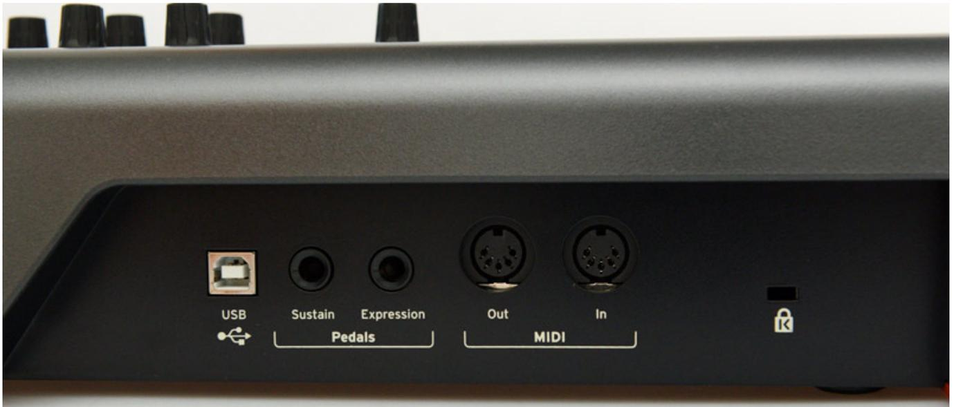
Auch was die Anschlüsse angeht ist das Novation Impulse 25 besser ausgestattet als das Novation Launchkey denn es bietet Anschluss von zwei Pedalen und bietet auch MIDI-Ein- und Ausgang, so dass man auch direkt reale MIDI-Instrumente ansteuern kann. Die Spannungsversorgung erfolgt über USB.
