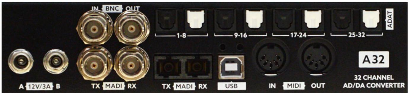
Digitale Schnittstellen sind in Form von vier ADAT-I/Os sowie je koaxiale und optische MADI-I/Os. Wordclock I/O ist als BNC-Buchse (75 Ohm, Abschluss elektronisch schaltbar) ausgeführt. Die interne Clock bietet übrigens eine Genauigkeit von besser als +/-2,5 ppm.
