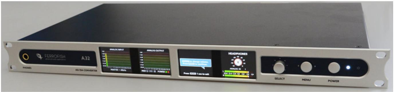
Ein Blick auf die Gerätefront offenbart, dass gleich vier Farb-TFT-Displays geboten werden, die je nach Anwahl eines Menüs/Dialogs entsprechend wechseln. Auf dem Beispiel (s. Abb. oben) sieht man z. B. links die Meter der Kanäle 1 bis 32 und dann die beiden anderen beiden Displays für das Kopfhörer-Monitoring.
