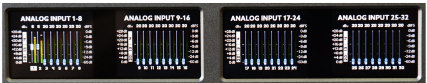
Hier als erstes (oben) die Displays bei der Anwahl des GAIN- (Eingangsempfindlichkeit, Abb. oben), bzw. LEVEL-Dialogs (Ausgangspegel, s. Abb. unten). Die entsprechenden Schaltbereiche für +4, +13 und +20 dBu Referenzpegel sind entsprechend links an der Skala vermerkt.
