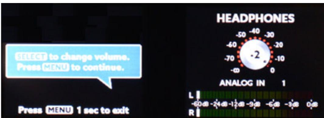
Sowohl der Kopfhörerpegel als auch die Quelle lassen sich hier anwählen. Neben den einzelnen Ein- und Ausgängen (sowohl Monoquellen als auch Stereoquellen von benachbarten Kanalpaaren wie 1/2, 3/4 etc.) lassen sich über den MIX-Dialog sieben
