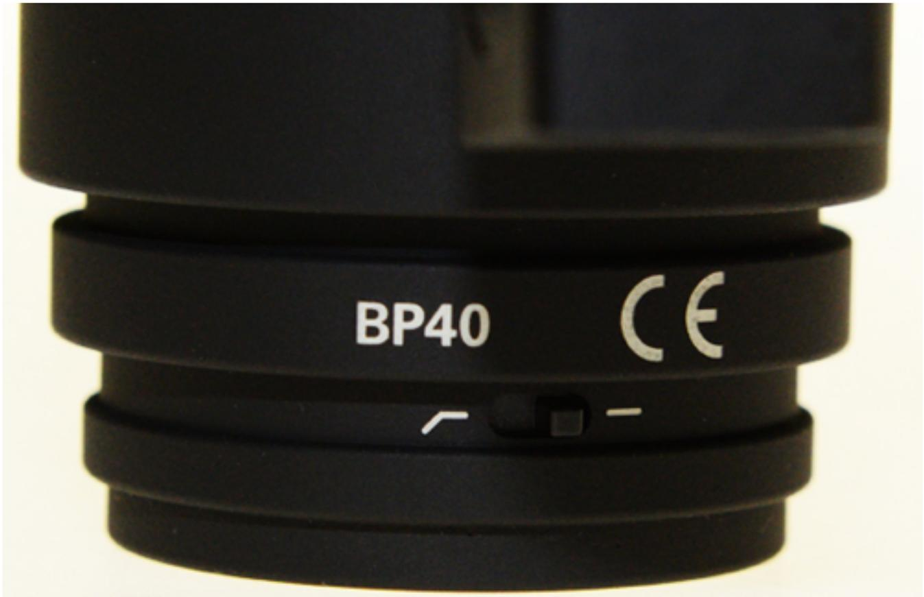
Als einziges Bedienelement gibt es einen Miniaturschalter im unteren Bereich des Mikrofons für die Zuschaltung eines 100-Hz-Hochpassfilters mit einer Filtersteilheit von 6dB/Okt. (s. Abb. oben).
