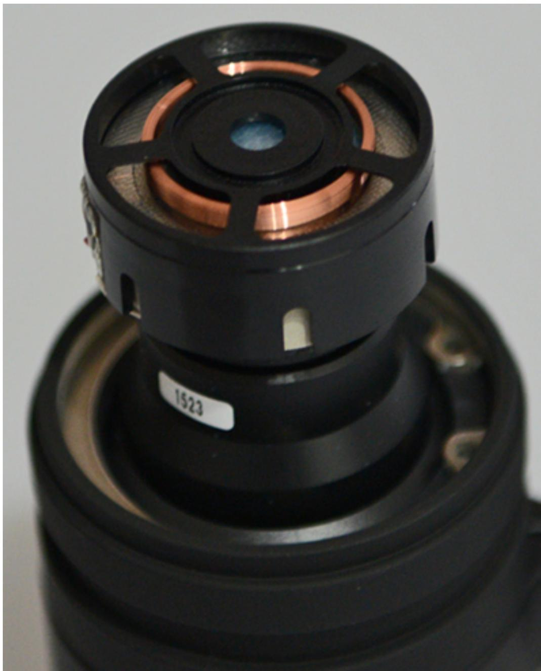
Die Mikrofonkapsel ist von einem sehr robusten Metallkorb geschützt, in dem auch mehrlagiger Schaumstoff eingelegt ist und so als mehrstufiger Windschutz fungiert. Die Nominalimpedanz beträgt 450 Ohm und ist damit bewusst höher als bei vergleichbaren Mikrofonen. Angeschlossen wird das Mikrofon über die integrierte dreipolige XLR-Buchse.
