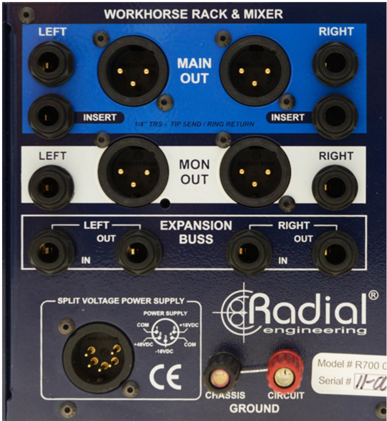
Neben dem 5-Pin-Netzteilanschluss befinden sich die beiden Erdungsanschlüsse Chassis und Circuit. Diese sind für die Anbindung an eine professionelle Studioverkabelung gedacht, ein lobenswertes Detail.
