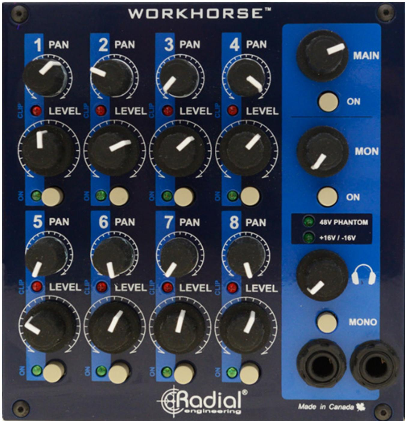
Auf der Vorderseite befindet sich rechts neben den acht Modulslots das Mischpult. Pro Kanal gibt es einen Panregler, einen Volumeregler, einen An/Aus-Schalter nebst grüner Status-LED sowie eine rote Clip-Indikator-LED für die Pegelüberwachung. Das Anliegen der Stromversorgung wird für die +/-16 Volt sowie für die 48-Volt-Phantomspeisung mittels zweier LEDs angezeigt.
