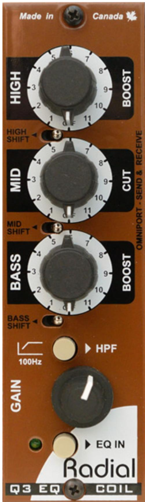
Ganz unten befindet sich ein Schalter um den EQ in den Signalweg einzuschleifen, bzw. in Bypass zu schalten. Mit dem Gain-Regler (max. 7 dB Verstärkung ohne Filterstufen) lässt sich die generelle Verstärkung einstellen. Über dem Regler befindet sich ein Schalter für die Aktivierung eines 100-Hz-Hochpassfilters (-3 dB bei 150 Hz).
