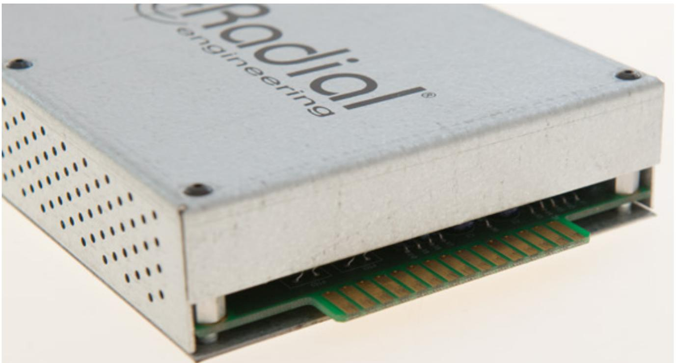
Die Eingangsimpedanz des Moduls beträgt 12 kOhm und Ausgangsimpedanz 440 Ohm (symmetrisch). Der maximale Eingangspegel beträgt +20 dBu, der Noise Floor 90 dBu (bei ausgeschalteten Filtern), bzw. 87 dBu (aktivierte Filter), bei einem Dynamikbereich von 112 dB. Den Frequenzgang gibt der Hersteller Radial mit 20 Hz bis 20 kHz (+/-1 dB) bei ausgeschalteten Filtersektionen an und den THD bei 0,003 % (@ 0 dBu und 1 kHz). Die Stromaufnahme beträgt lediglich 25 Milliampere.
