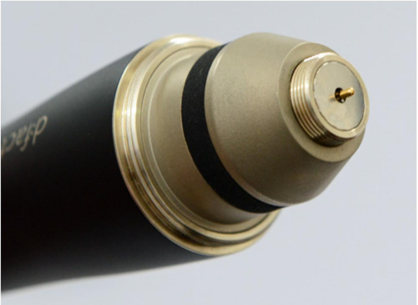
Das eigentlich Neue ist die Kapsel vom Typ 2006V mit 19 mm Durchmesser (s. Abb. unten). Es handelt sich um ein Druckempfänger - also um eine Kapsel mit Kugelrichtcharakteristik, die vorpolarisiert ist. Die Kapsel bietet durch Ihre technische Konzeption den Vorteil von kleinen (gute Impulsantwort und großer Übertragungsbereich) und großen Kapseln (geringes Rauschen).
