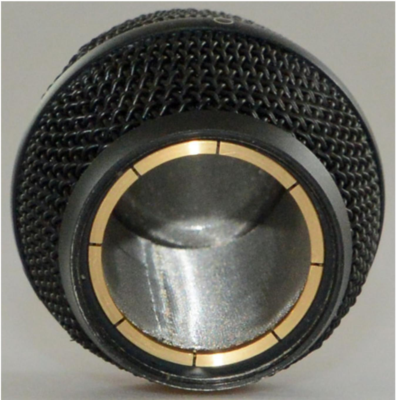
Was weiter sofort auffällt ist die sehr geringe Empfindlichkeit gegenüber Windgeräuschen, was am Kapseldesign liegt, aber auch an dem Design des Mikrofonkorbs (s. Abb. oben), der mehrlagig aufgebaut ist. Aber auch die Handhabungsgeräusche sind im Vergleich zu anderen Mikrofonen wirklich sehr gering. Beim Vergleich muss man darauf achten den Pegel anzupassen denn das d:facto II Interview Microphone produziert durch seine Empfindlichkeit ordentlich Pegel am Ausgang.
