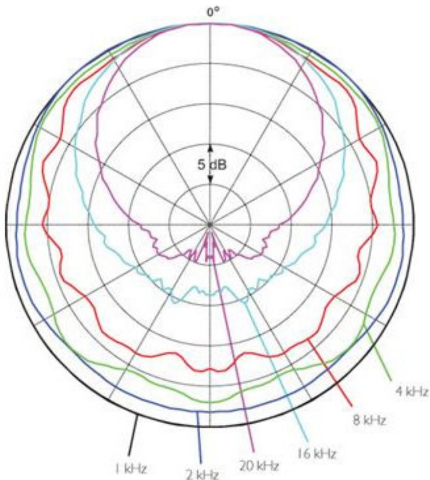
Die Richtcharakteristik ist ja eine Kugel. Ein genaueren Blick auf das Polardiagramm offenbart, dass ein Vor/Rückverhältnis von 6 dB bei ca. 8 kHz Grenzfrequenz erreicht wird. Bei 16 kHz beträgt die Vor/Rückdämpfung 16 dB. Eine Klangverfärbung bei leichtem Wegdrehen ist daher auch nicht wahrnehmbar. Im praktischen Betrieb reicht daher eine grobe Ausrichtung auf den Interviewpartner aus.
