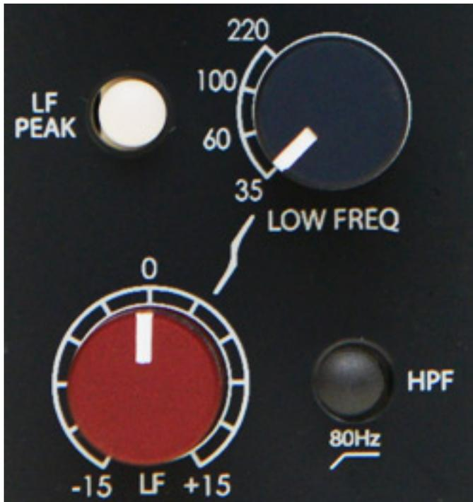
Die Frequenzen des unteren Bandes können zwischen 35, 60, 100 und 220 Hz umgeschaltet werden. Die Umschaltung der Frequenzen erfolgt mittels Relais. Auch hier wird eine kontinuierliche Pegelveränderung von +/-15 dB geboten. Eine Peak/Shelf-Umschaltung ist ebenfalls vorhanden. Zusätzlich steht noch ein zuschaltbarer Hochpassfilter mit einer Grenzfrequenz von 80 Hz und einer Steilheit von 12dB/Oktave zur Verfügung.
