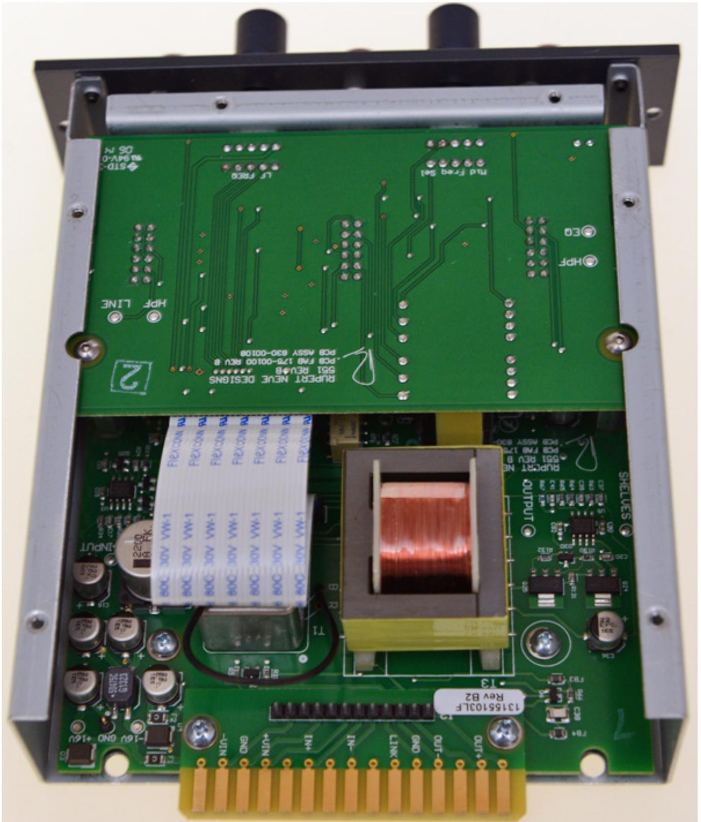
Der EQ ist mit einem geschirmten Eingangsübertrager sowie mit einem ungeschirmten Ausgangsübertrager bestückt. Auf der in moderner SMD-Technologie bestückten Hauptplatine kommt ein Induktor zum Einsatz, der RND 551 basiert also
