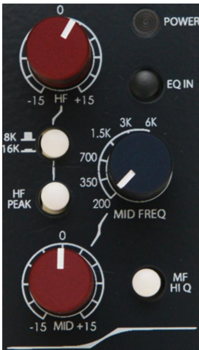
Die Mittenfrequenz ist zwischen 200, 350, 700 Hz, 1,5, 3 und 6 kHz wählbar und auch hier kann der Pegel zwischen +/- 15 dB kontinuierlich verändert werden. Es gibt einen mit MF HI-Q beschrifteten Schalter, der zwischen zwei unterschiedlichen
