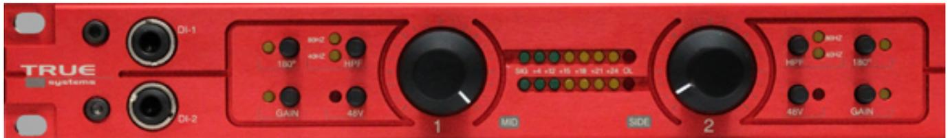
Auf der linken Seite der Frontplatte sind die beiden identischen Sektionen für die Eingangskanäle zu finden. Für jeden Kanal lässt sich individuell Eingangsabschwächung, bzw. zwei Verstärkungsbereiche, die Phasenumkehrung, 48-Volt-Phantomspeisung sowie ein Hochpassfilter, mit einer Grenzfrequenz von 40 oder 80 Hz, zuschalten. Neben den beiden Potis für die Stufenlose Einstellung der Verstärkung ist je ein LED-Bargraf-Aussteuerungsanzeige (8 LEDs) zur Kontrolle des Eingangspegels vorhanden.
