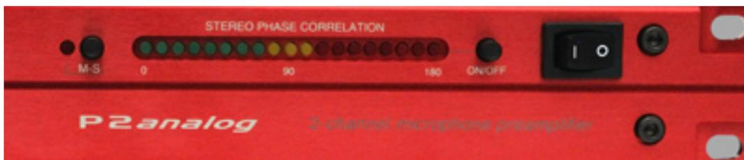
Neben dem M/S-Umschalter befindet sich eine Korrelationsanzeige in Form eines Bargraphs mit 20 LEDs zur Kontrolle der Phase, bzw. Stereo-Korrelation. Über einen weiteren Schalter kann man diese Anzeige auch bei Bedarf ausschalten.
