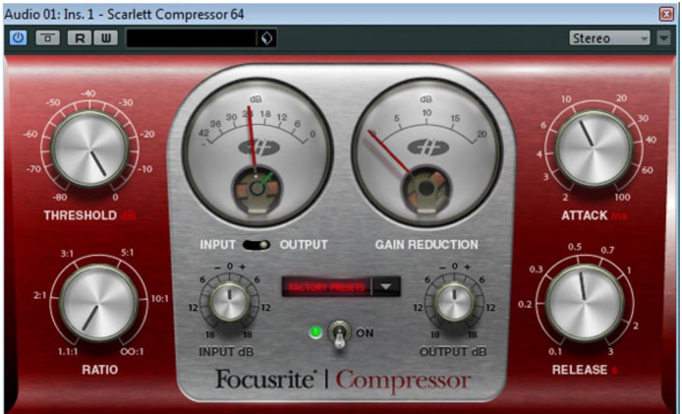
Der Focusrite Compressor ist ganz klassisch aufgebaut und bietet Parameter für Schwellwert, Kompressionsverhältnis und Anstiegs- und Abfall-Zeitkonstanten sowie Ein- und Ausgangspegelanpassung. Wie bei allen Plug-Ins der Focusrite Plug-In-Serie lassen sich auf Werkseinstellungen aufrufen.
