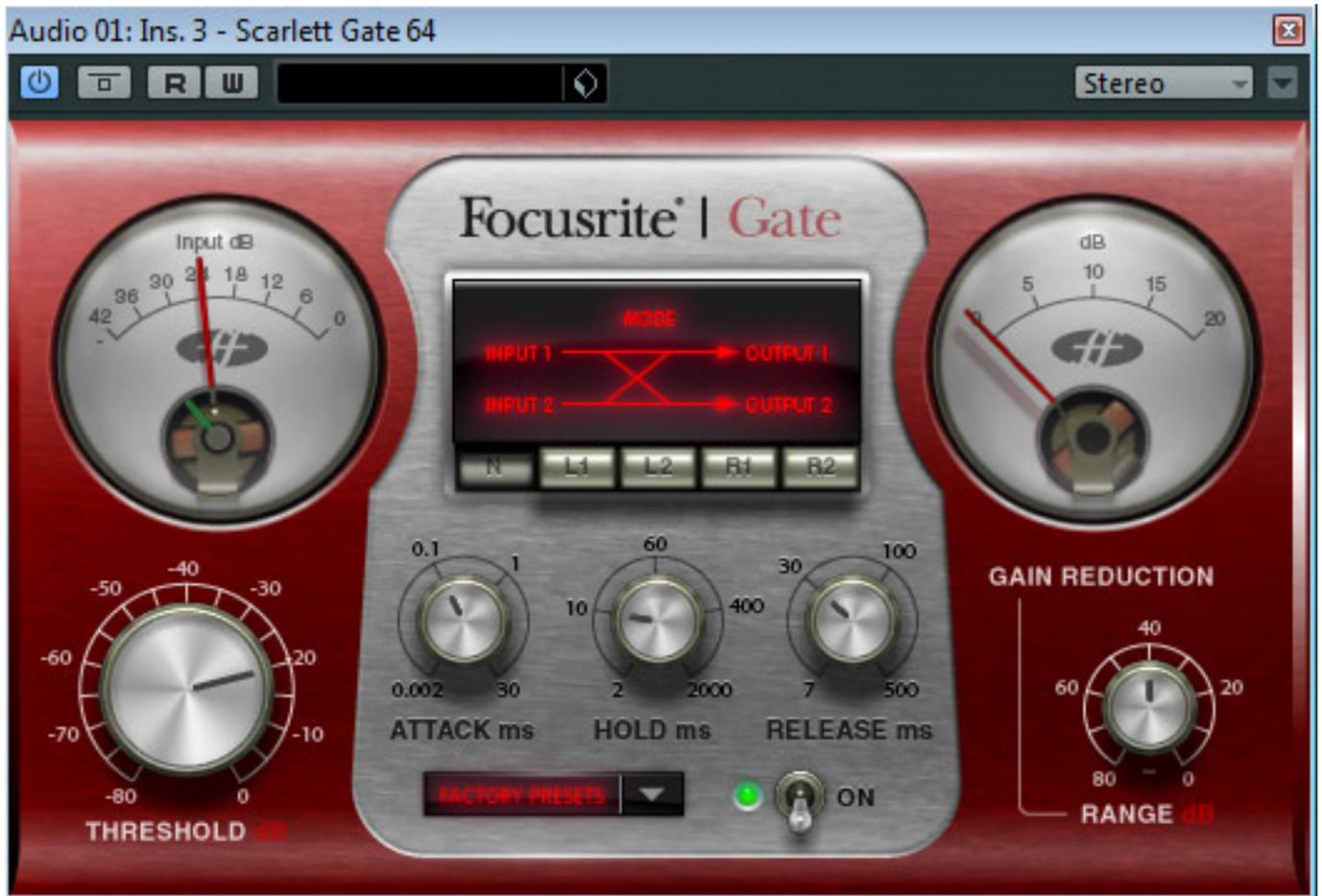
Schon das Focusrite Gate zeigt mit den vielen Funktionen, dass die Plug-Ins alles andere als nur ein kleines Beiwerk sind. Schwellwert, Gain-Reduzierung und die Zeitkonstanten Attack, Hold und Release lassen sich einstellen und das Gate kann in fünf verschiedenen Link-Betriebsarten gefahren werden.
