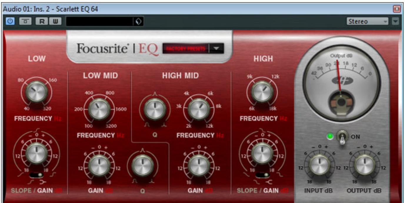
Natürlich darf auch ein Equalizer nicht fehlen, der hier als zweifach vollparametrischer Mitten-EQ und Shelving, bzw. Low- und /High-Filter mit Slope-, bzw. Gain-Einstellung, ausgeführt ist.
