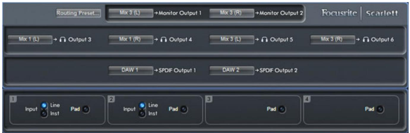
Im unteren Bereich lassen sich die vier Eingängskanäle fernsteuern. Neben der Umstellung Line/Instrument-Pegel bieten die ersten beiden Eingänge auch noch eine schaltbare Pegelabschwächung (Pad) um 10 dB.
