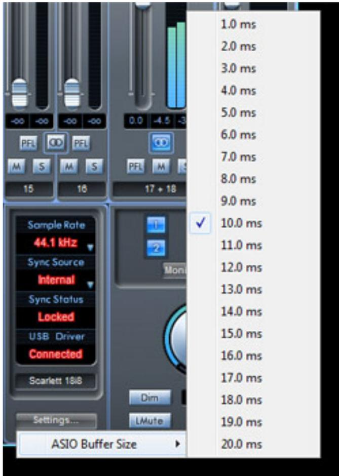
Über den Settings-Button lässt sich die Audiodaten-Puffergröße zwischen einer und 20 Millisekunden einstellen (s. Abb. oben).
