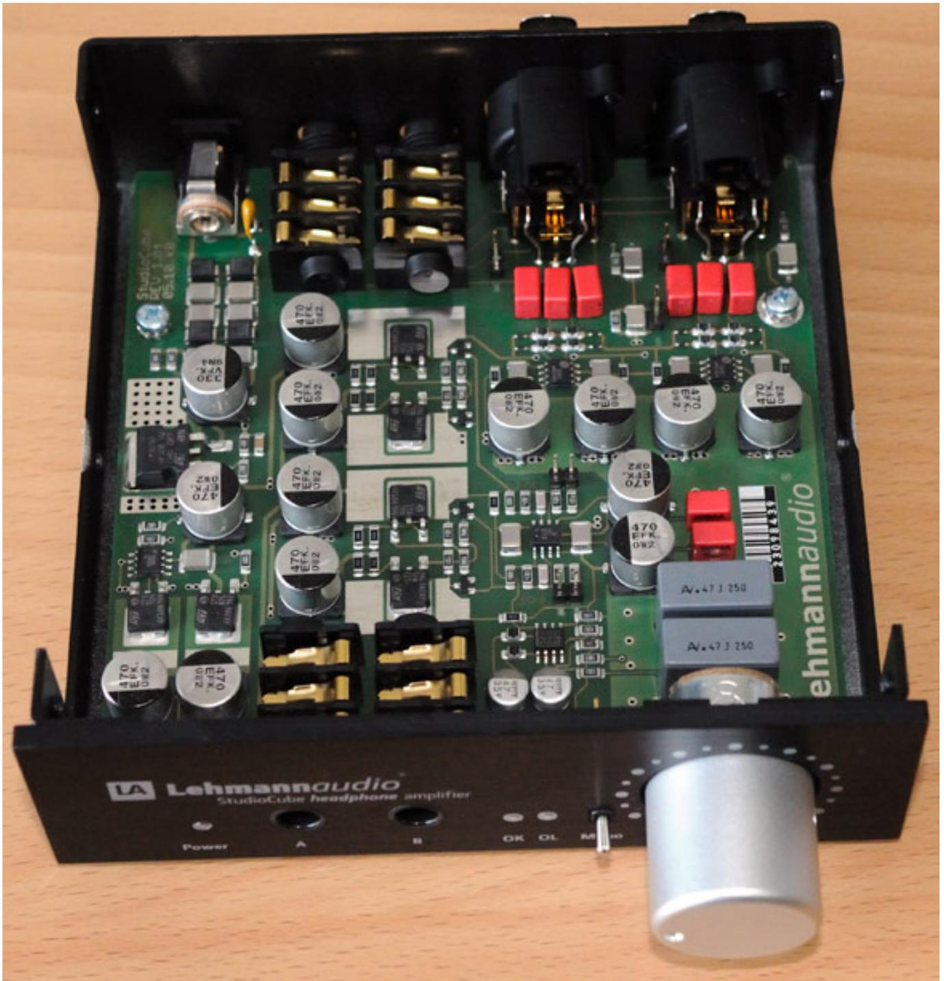
Im Gerät lassen sich über Jumper noch einige Einstellungen vornehmen, wie z. B. eine Verstärkung von +6 dB und eine Masse-Aufschaltung (Audiomasse an Gehäusemasse).
