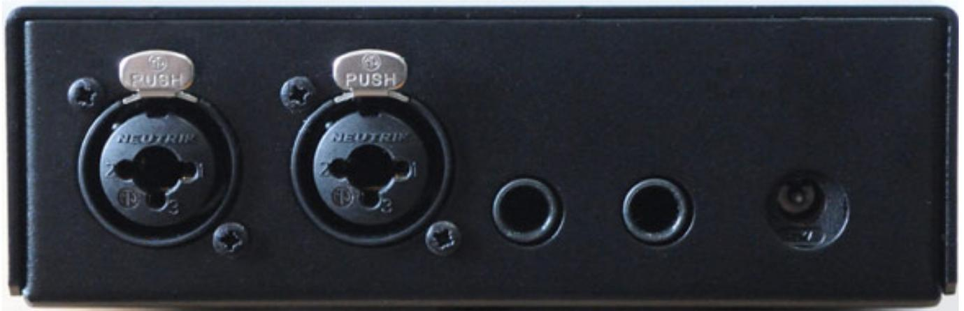
Auf der Rückseite befinden sich zwei Eingänge (XLR, elektronisch symmetriert) sowie zwei Ausgänge (6,3-mm-Stereoklinke) zum Durchschleifen für Kaskadierung mehrerer Kopfhörerverstärker sowie der Anschluss für die 24-Volt-Spannungsversorgung. Betrieben wird der StudioCube mit einem mitgeliefertem, externen Steckernetzteil. Die Eingangsimpedanz beträgt 22 kOhm und der maximale Eingangspegel kann +22 dBu betragen.
