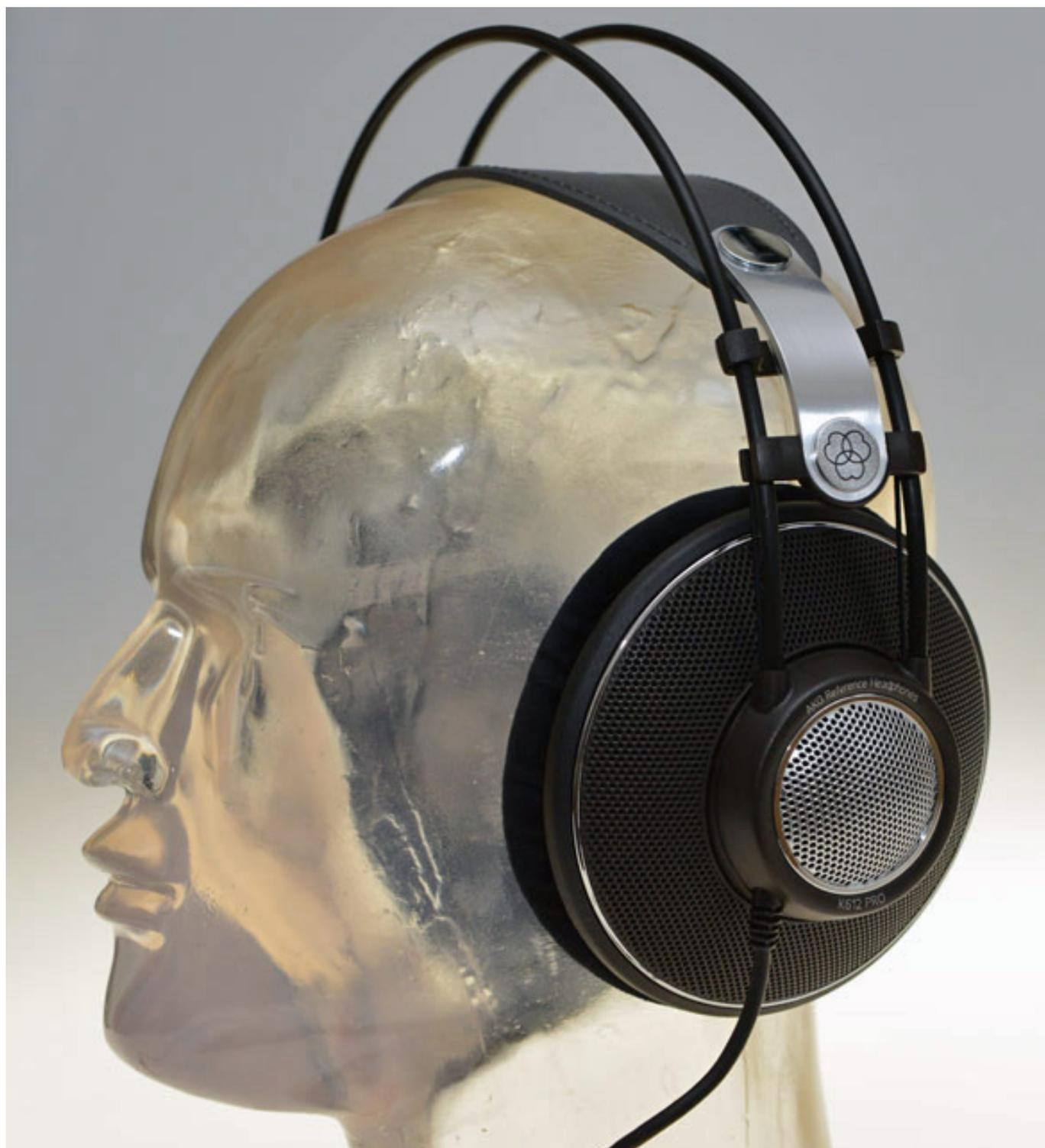
Der K612 ist der preiswerteste im Bunde der drei neuen AKG Kopfhörer. Es basiert technisch auf den K602 in offener Bauweise und bietet gegenüber dem Vorgänger leichte optische Veränderungen und nun einen 3,5 mm Klinkestecker mit 6,3 mm Aufschraubadapter. Der Treiber (Flachspule und Neodym-Magnet) und die akustische Abstimmung entsprechen dem K602 und somit wurde der Vorgänger auch komplett aus dem Programm genommen. Mehr zu dem Hörer im
