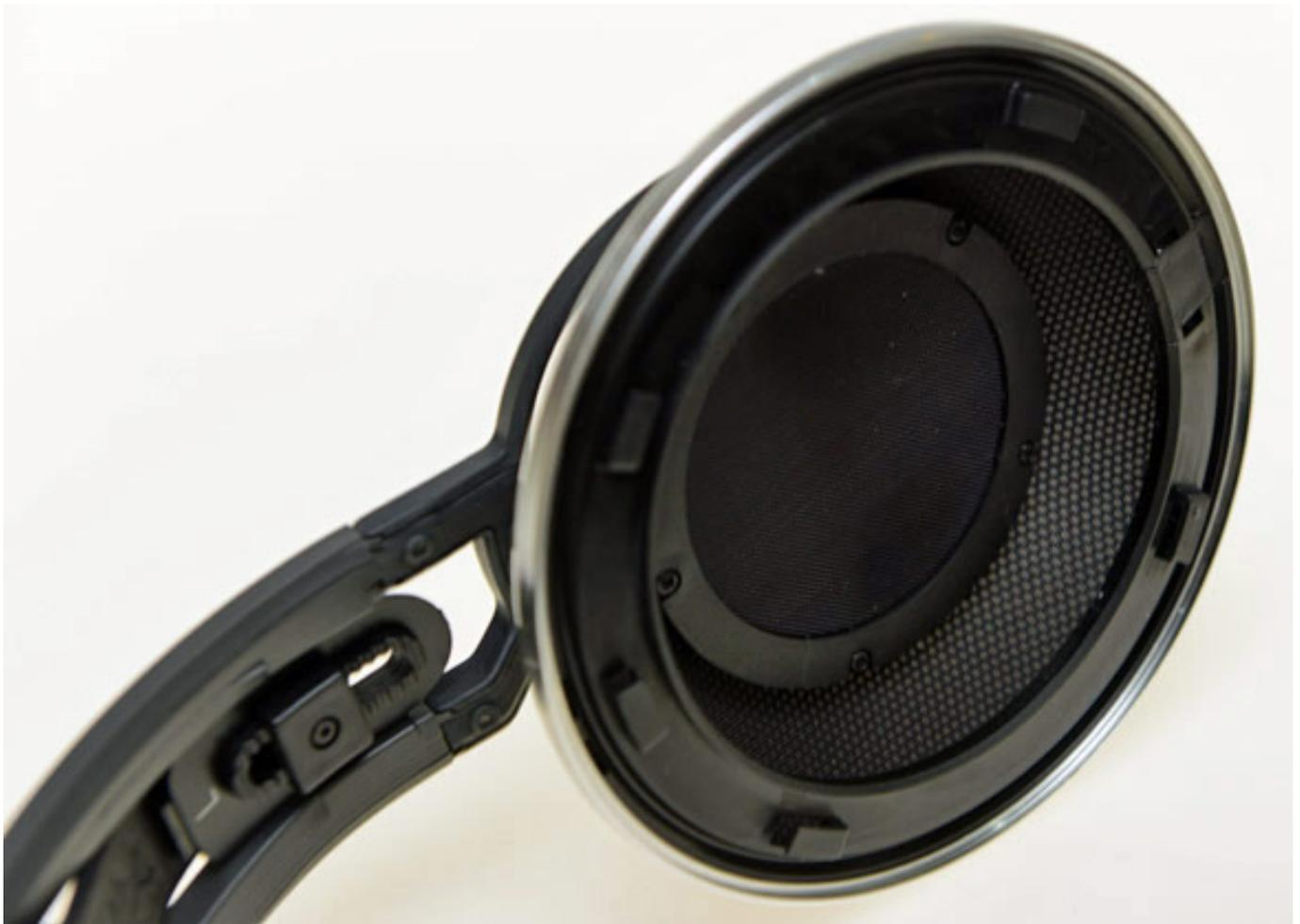
Schon beim Abnehmen des Ohrpolsters sieht man, dass der Aufbau am Übergang zum Ohr komplett anders gelöst ist als beim K 712. Der Raum zwischen dem Ohr und dem Wandler hat ja einen Einfluss auf den Frequenzgang.
