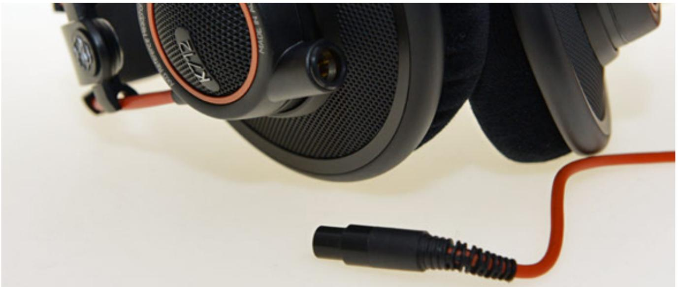
Wie auch schon beim K702 ist beim K 712 das Kabel abnehmbar. Es wird über eine Mini-XLR-Verbindung am Hörer angesteckt. Der Hörer wird in einer Tragetasche geliefert wobei noch ein Spiralkabel mitgeliefert wird. Die Polster sind, wie bei allen drei vorgestellten Kopfhörern, über Drehen abnehmbar und lassen sich so leicht austauschen.
