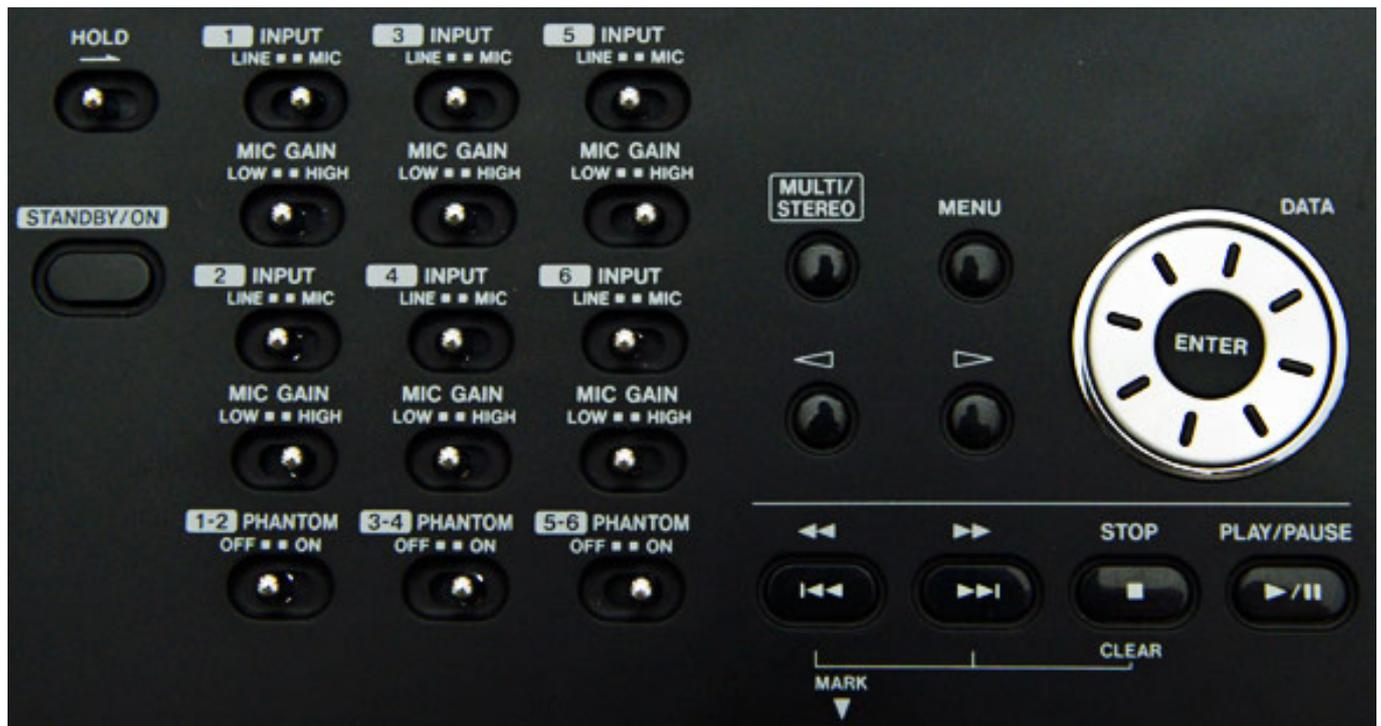
Über den Taster MULTI/STEREO kann zwischen der konfigurierten Mehrkanalaufnahme - dazu später mehr - und Stereobetrieb umgeschaltet werden, ohne ein Menü aufzurufen.
