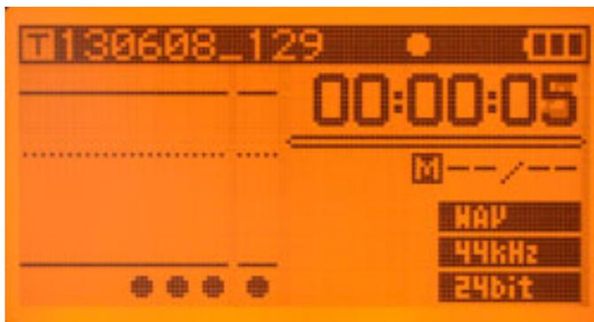
Im Play/Record-Betrieb wird Dateiname, Play/Stop-Status, die Zeit, bzw. Restzeit, Batteriestatus/Netzbetrieb, Audioformat (WAV, BWF, MP3) sowie Abtastrate und Wortbreite angezeigt. Mit dem Display-Taster kann man zwischen Zeit und Restzeitanzeige hin- und herschalten. Über den Taster MARK kann man während des Aufnahme oder Wiedergabe Marken setzen. Mit Hilfe der Sprungtasten auf der Oberseite lassen sich die Marken dann anspringen.
