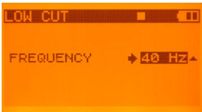
Im Menüdialog LOW CUT lässt sich die Grenzfrequenz des Hochpassfilters auf 40, 80 oder 120 einstellen. Die Aktivierung des Hochpass selbst erfolgt ja über das zuvor erwähnte Funktionsmenü.
