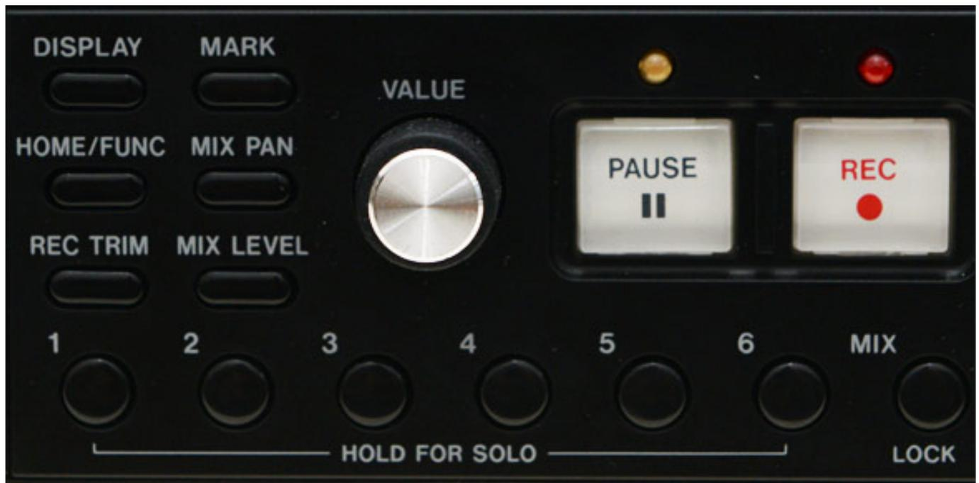
Weitere Tasten befinden sich auf der Gerätevorderseite, wie die für Pause und Record, die je mit einer Indikator-LED versehen sind. Weiterbefindet sich neben diesen Tasten ein weiterer Drehgeber und zwar mit Drucktasterfunktion. Zu den anderen Tasten kommen wir gleich.
