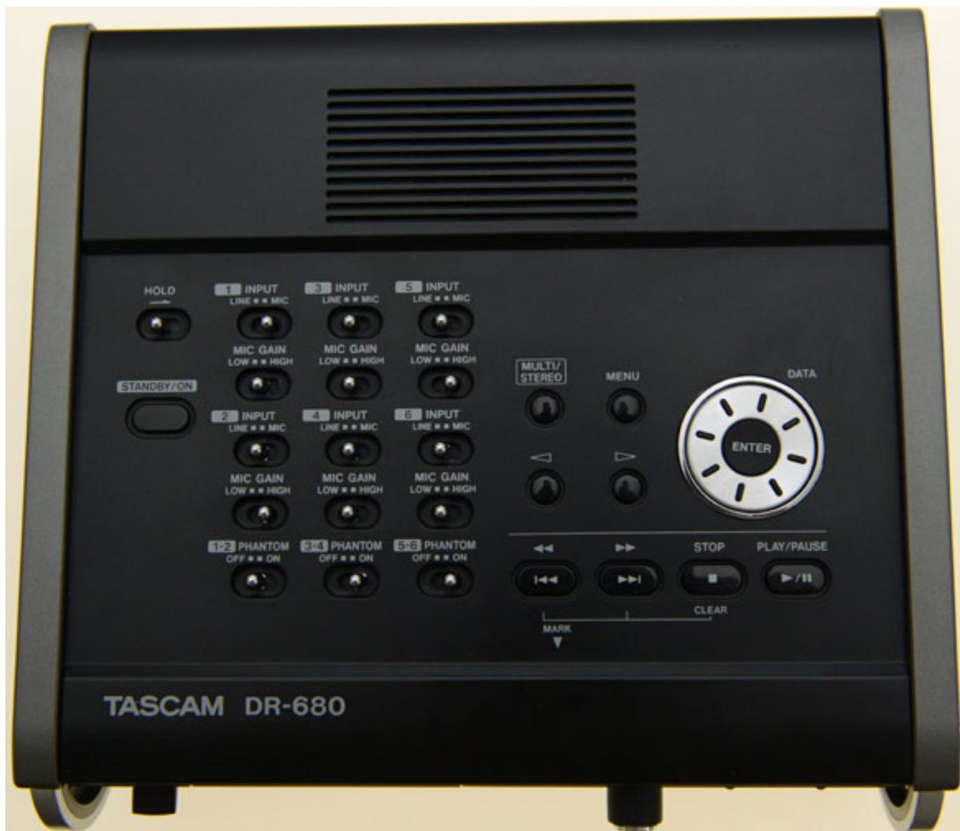
Über dem STANDBY/ON-Taster auf der Geräteoberseite, befindet sich ein HOLD-Schalter, mit dem ein Ausschalten über den STANDBY/ON-Taster gesperrt wird. Daneben sind für jeden der sechs Eingangskanäle Schalter für Mic/Line-Pegel, Mikrofonverstärkung (Low/High), sowie in Paaren zusammengefasst, Schalter für die zuschaltbare 48-Volt-Phantomspannung.
