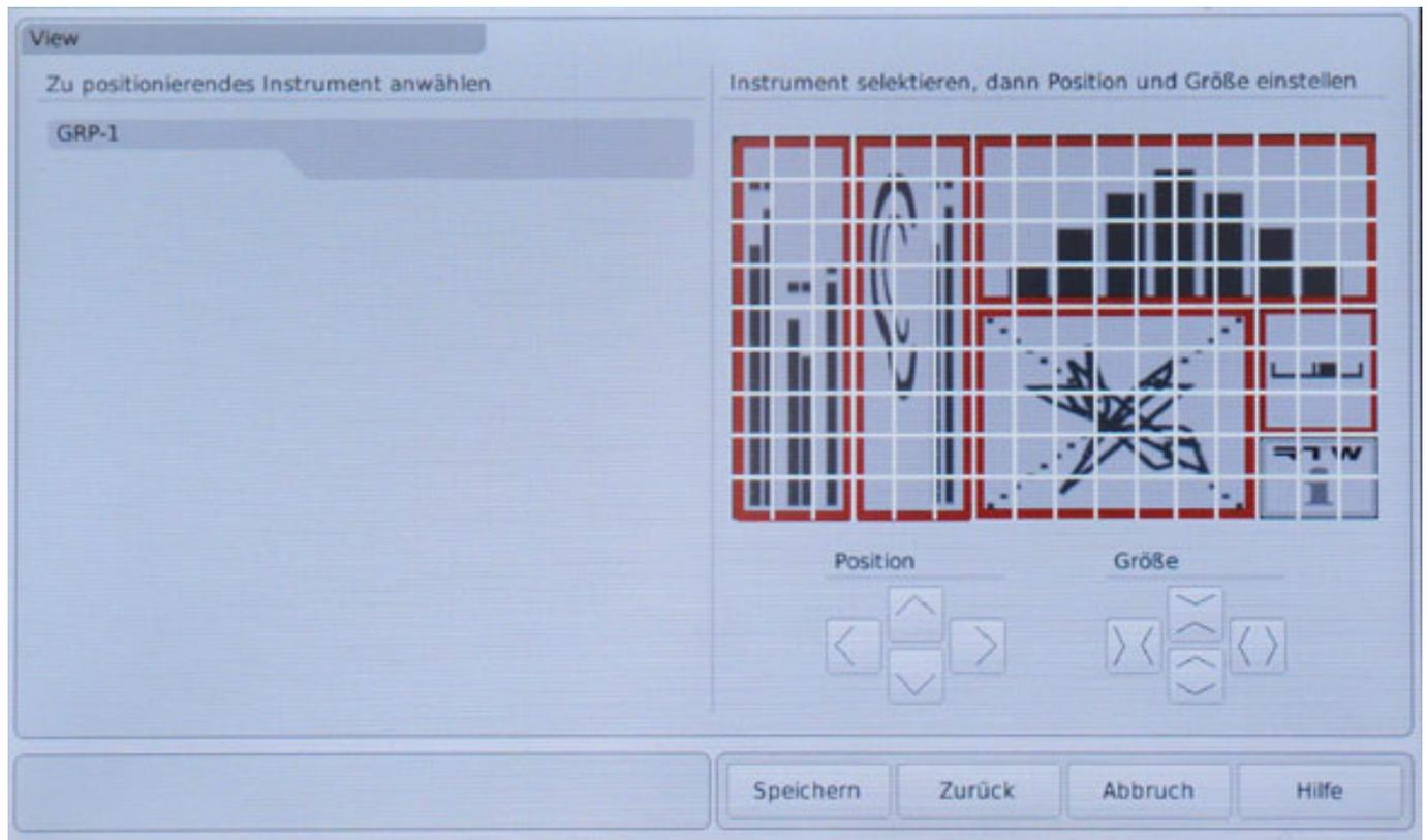
In dem Menü "Aktuellen View editieren" wird der Bildschirm mit den verfügbaren 144 Blöcken im 16:9-Format dargestellt. Das zu positionierende Instrument wird per Bildschirmberührung selektiert. Zur Positionsänderung stehen vier Pfeilbuttons zur Verfügung (s. Abb. oben). Die Größenänderung eines Instruments wird mit weiteren vier Buttons vorgenommen.
