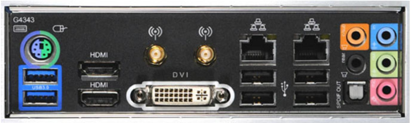
Es gibt insgesamt vier USB 3.0-Anschlüsse, zwei befinden sich auf der Rück-, zwei auf der Vorderseite des Computers. Neben den beiden frontseitigen USB 3.0-Buchsen befindet sich noch ein eSATA-Anschluss für eine externe Festplatte. Auf der Rückseite befinden sich vier USB 2.0 Anschlüsse, darüber die beiden Gigabit-Ethernet-Ports. Tastatur und Maus können über eine PS2-Kombibuchse angeschlossen werden.
