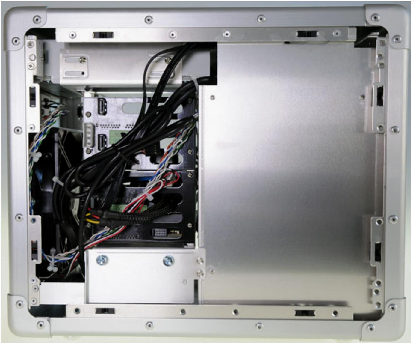
Der SO-MPC1 wird vom Hersteller mit verschiedenen Festplattenkonfigurationen angeboten. Für die Systemplatte (HDD1) kann der Kunde zwischen einer 120 GB SSD oder einer 500 GB HDD-Platte mit 7200 rpm und 64 GB Cache wählen. Zur Datenaufzeichnung (HDD2) werden Platten mit einer Kapazität von 500 GB, 1 TB, 2 TB oder 3 TB angeboten (RAID Edition). In der Standardkonfiguration wird der Rechner mit einer 1 TB HD ausgeliefert.
