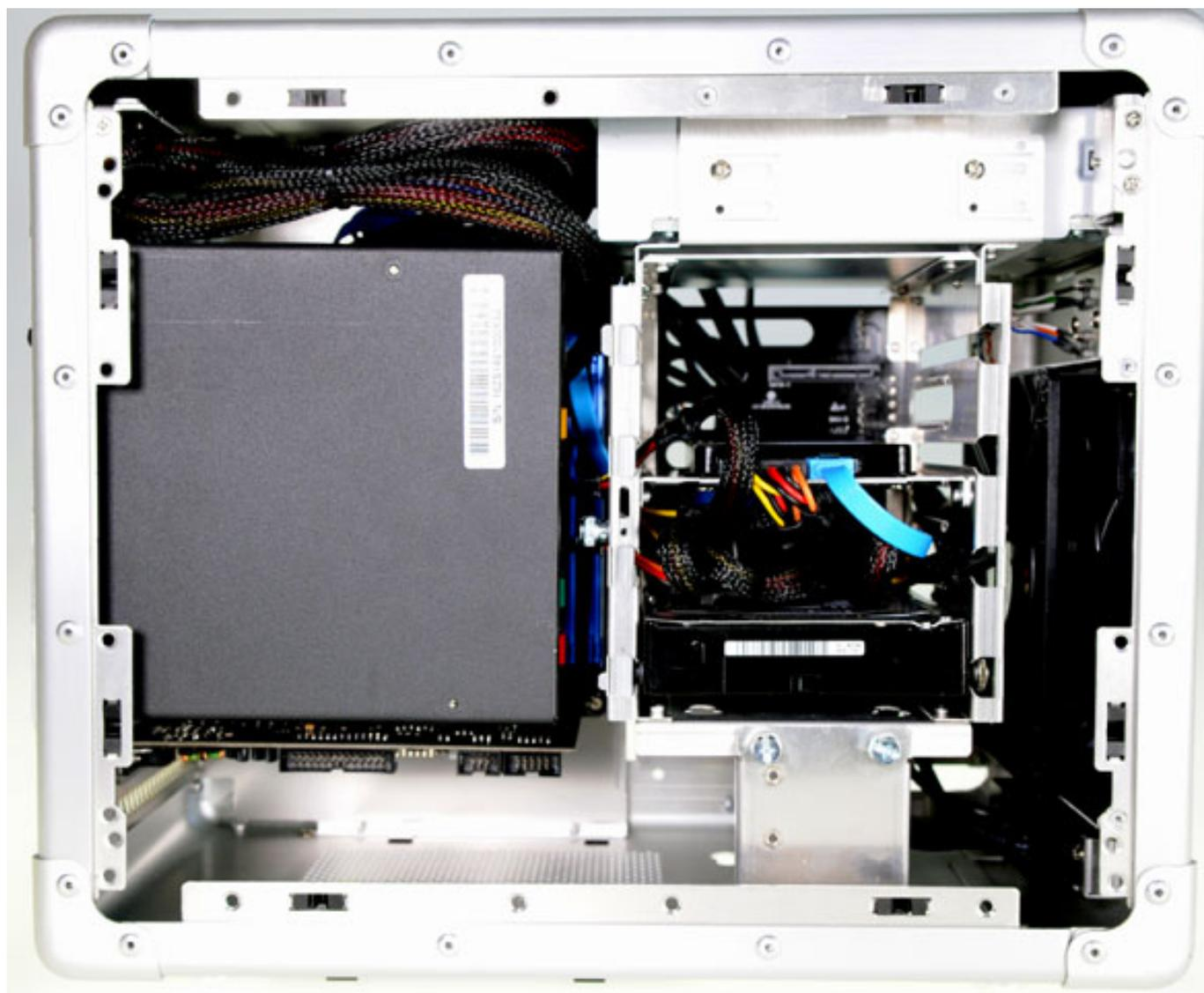
Der SO-MPC1 stellt einen PCIe-Steckplatz in voller Länge zur Verfügung. Hier lässt sich je nach Einsatzgebiet, eine entsprechende professionelle Audio- oder Videokarte einsetzen. Unter dem PCI-Kartenslot befindet sich noch ein weiteres Slot-Blech, das für eventuelle Anschlussweiterungen ausgebaut werden kann.
