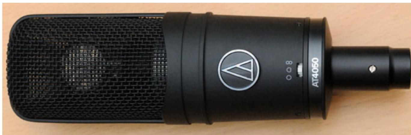
Die Richtcharakteristik des Mikrofons lässt sich auf der Frontseite über einen Miniaturschalter auf Kugel, Niere und Acht umschalten. Auf der Mikrofonrückseite kann man über zwei weitere Miniaturschalter eine 10-dB-Dämpfung sowie ein 80-Hz-Hochpassfilter (Filter 1. Ordnung) zuschalten.
