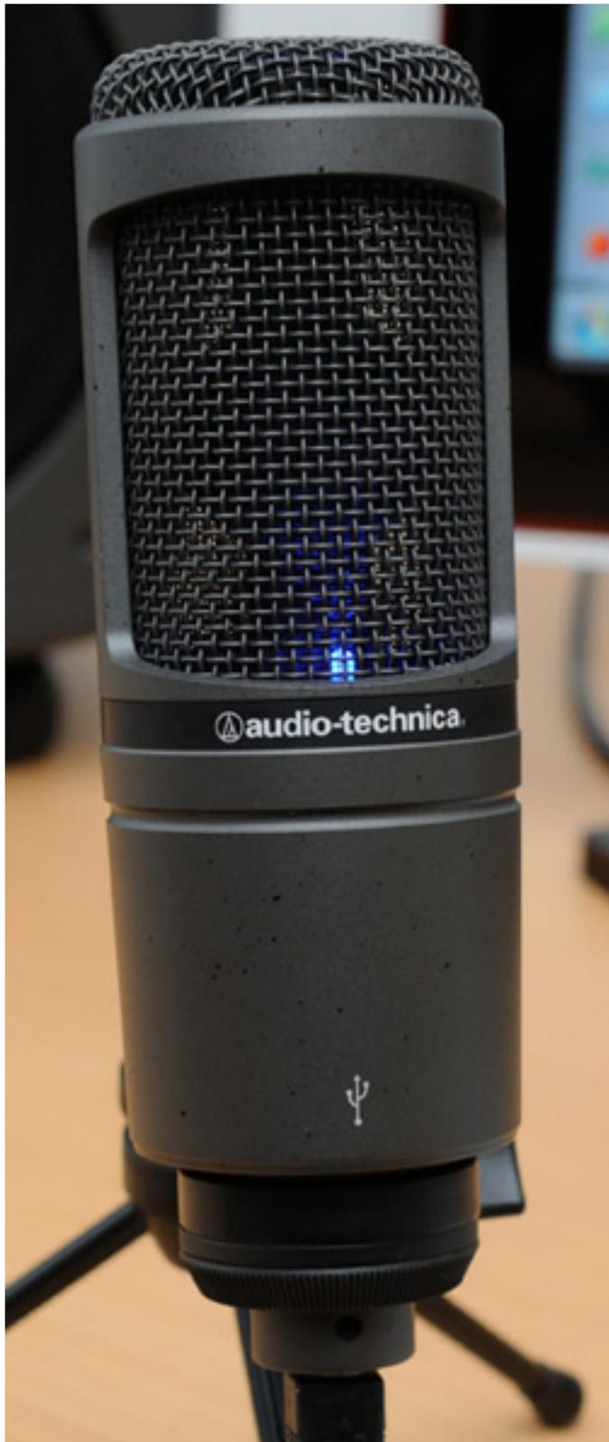
Das Mikrofon ist mit einer permanent polarisierten Elektret-Kondensatorkapsel mit Nierenrichtcharakteristik ausgestattet. Die Einsprechrichtung ist seitlich. Der Kapseldurchmesser beträgt 16 mm.
