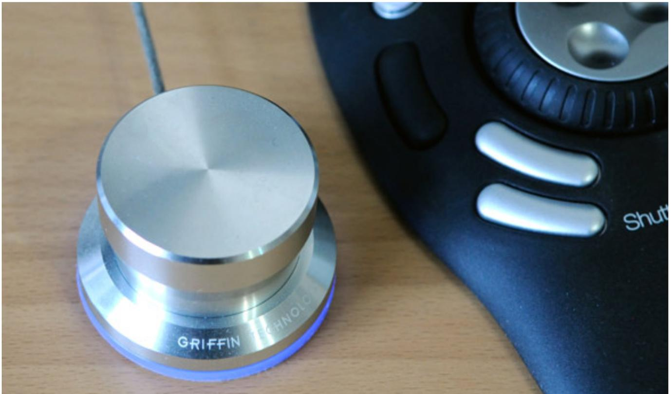
Die GLM Software ist für den Betrieb des PowerMate von Griffin ausgelegt. Mit diesem Regler kann man eine PegelEinstellung ohne Mausbetätigung durchführen. Zudem gestattet er durch kurzen Antippen eine Stummschaltung zu aktivieren, bzw. deaktivieren und auch ein Bassmanagement Bypass lässt sich durch langes Drücken des Reglerknopfes auslösen.
