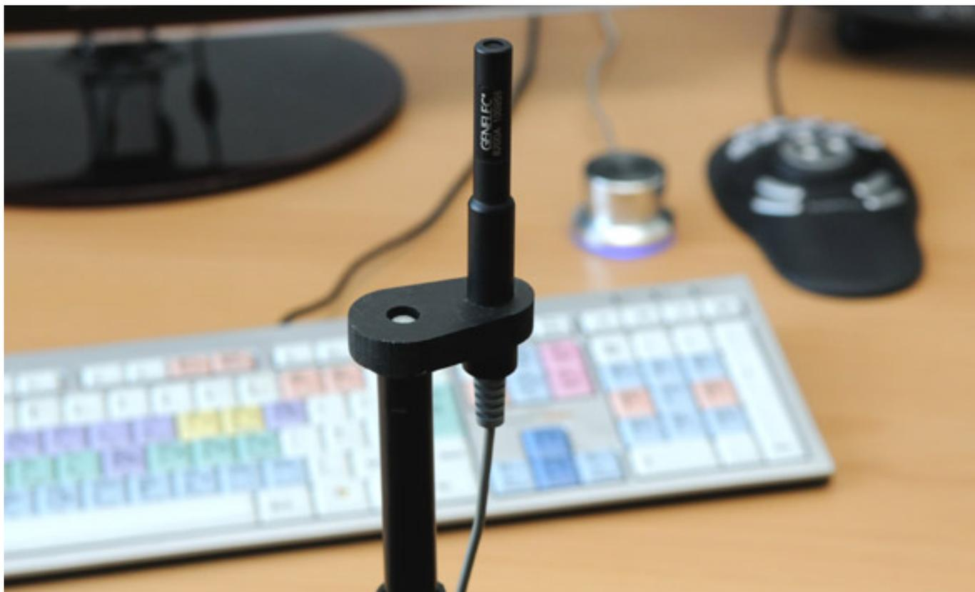
Das Messmikrofon ist nun an das GLM Network Interface anzuschließen und auf einem Mikrofonständer an der gewünschten Abhörposition aufzubauen. Das Mikrofon steckt in einer Gummihalterung zur akustischen Entkopplung.
