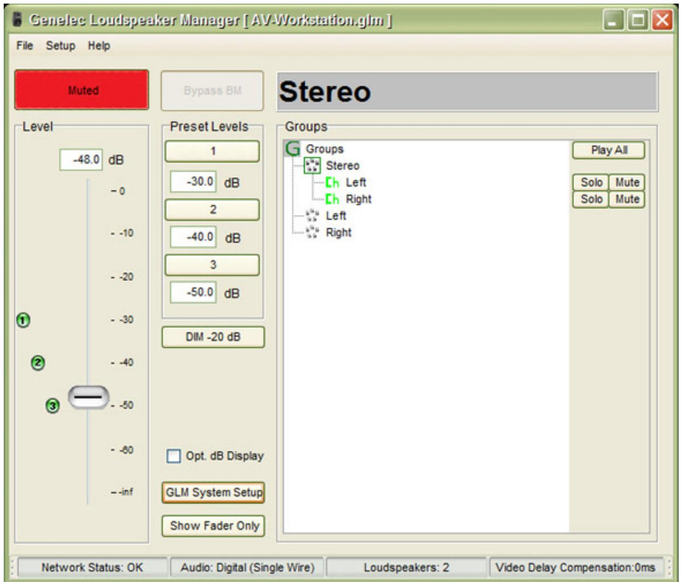
Mit dem virtuellen Regler lässt sich der Lautsprecherpegel einstellen. Über drei vordefinierte Pegel ist auch die Anwahl von Referenzpegeln leicht möglich. Weiter lässt sich das System auch komplett stummschalten, bzw. bei Anschluss eines Subwoofers auch das Bassmanagement deaktivieren.
