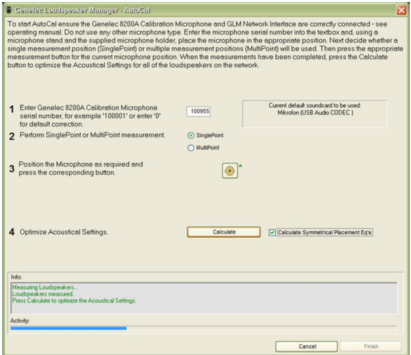
Nun wird eine Audiosequenz aus den Lautsprechern einzeln ausgegeben und nach Abschluss wird die Kompensation berechnet.
