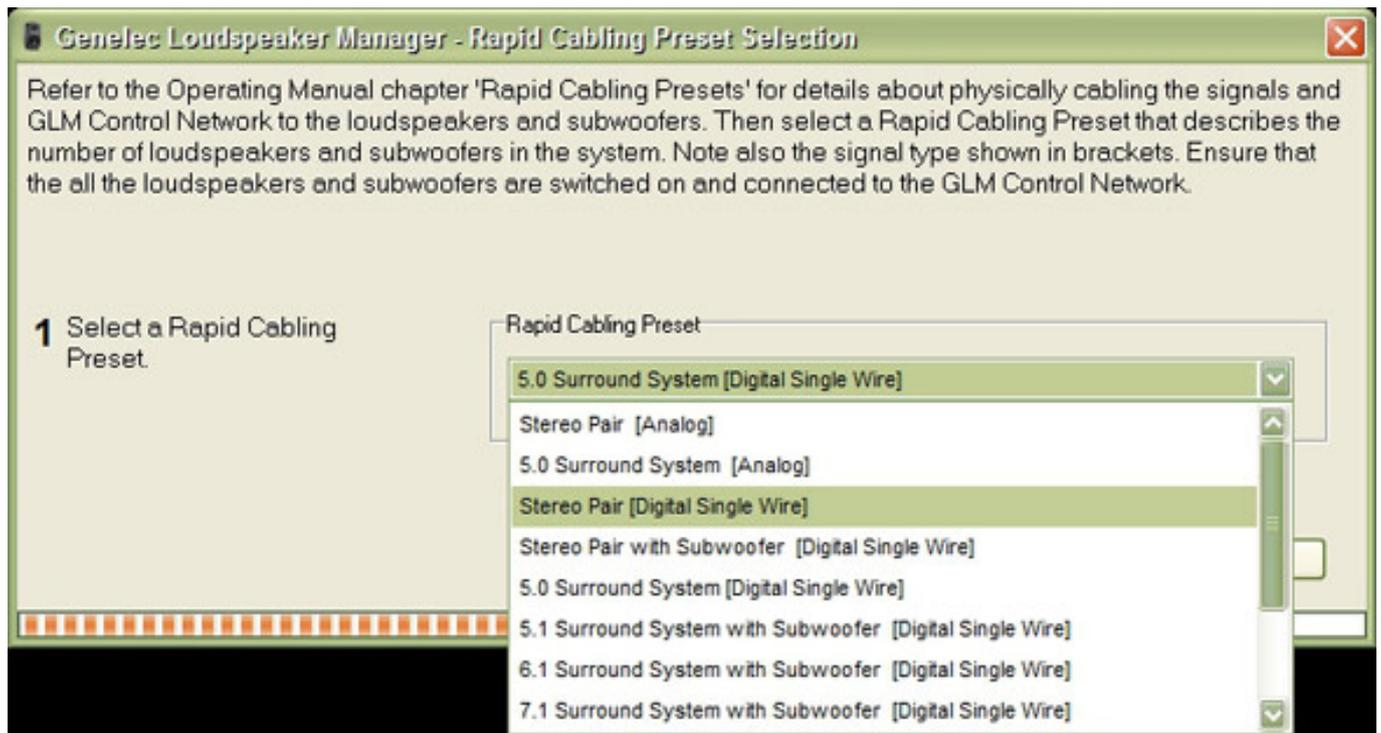
Die einzelnen Lautsprecher, inklusive der Subwoofer, werden nun virtuell verdrahtet (bei unserem Beispiel Stereo über digitale Schnittstellen) und den Kanäle zugeordnet (s. Abb. unten).
