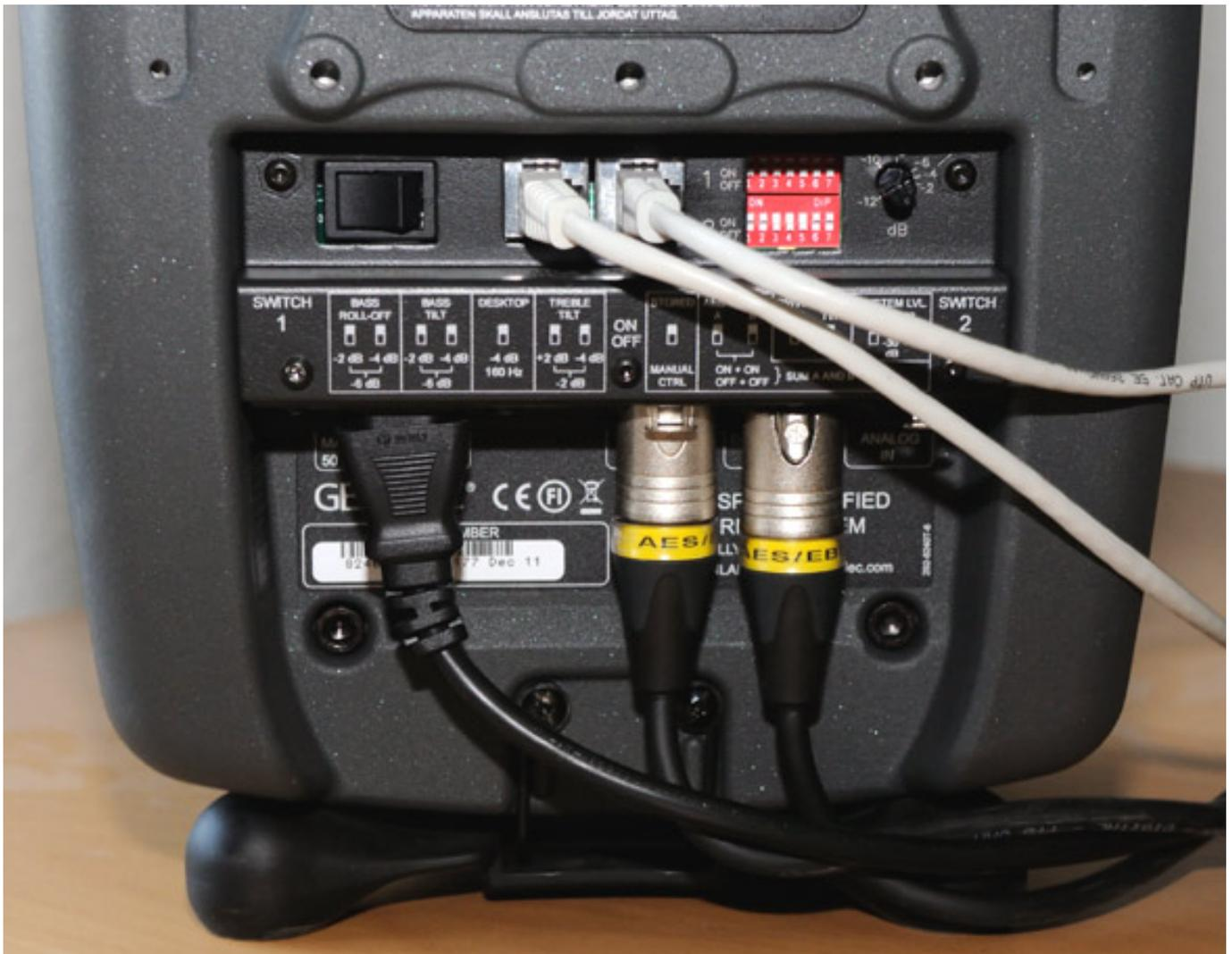
Jeder Lautsprecher verfügt über einen GLM-Netzwerk-Ein- und Ausgang. Der Ausgang führt zum nächsten Lautsprecher.
