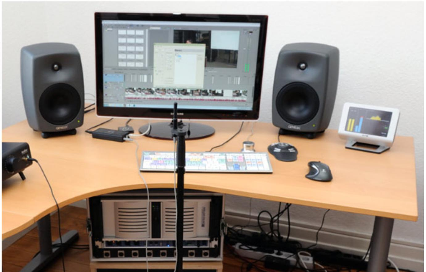
Auf diesem Foto (oben) sieht man, dass das System in einer Ecke aufgebaut ist, wobei links sich auch noch ein Fenster befindet. Also sehr unsymmetrische akustische Gegebenheiten.
