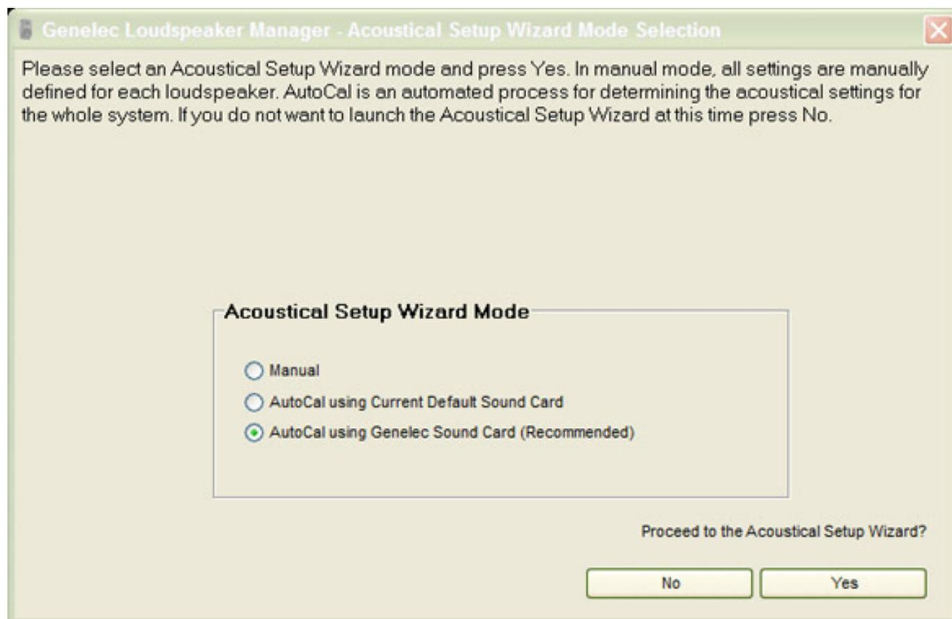
Nach dem Starten des Acoustical Setup Wizard wählt man die Art der akustischen Kompensation, bzw. Messung aus (manuell Einstellung ohne Messung, AutoCal mit der Standard-Soundcard im Rechner oder mit dem internen Audiointerface des GLM Network Interface).
