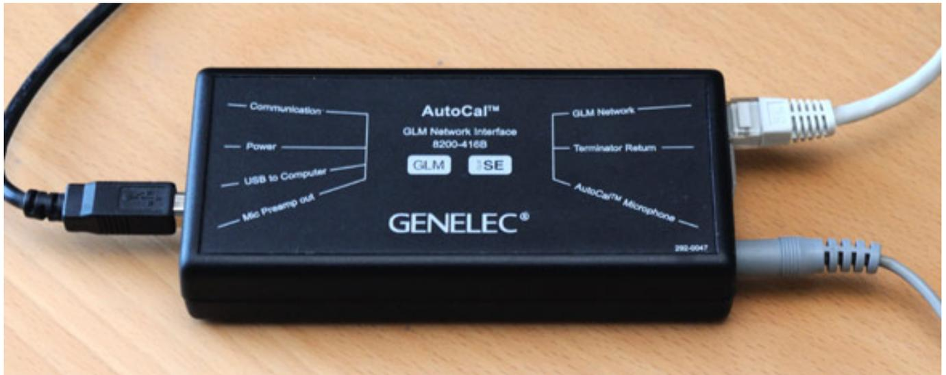
Die Verbindung mit dem PC erfolgt über das GLM Network Interface via USB-Schnittstelle. Hierzu ist noch ein Treiber zu installieren wobei die Installation aber automatisch erfolgt. Das Netzwerk-Interface dient nicht nur der Kontrolle der Lautsprecher sondern es verfügt auch über ein integriertes Audiointerface zum Anschluss des Messmikrofons für die AutoCal-Funktion, auf die wir später noch eingehen werden.
