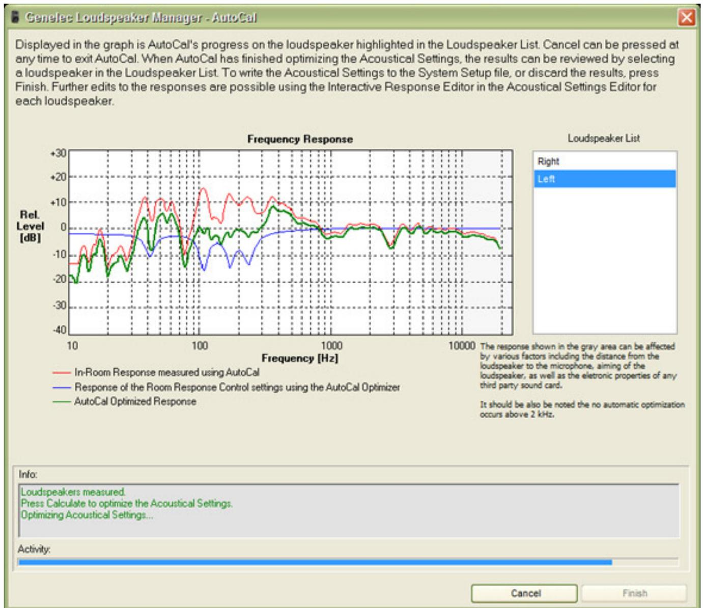
Man kann sich diese Kurven nun anschauen und beurteilen und auch sichern. Die Einstellungen und die AutoCal-Prozedur sind damit abgeschlossen. Die berechneten Kompensationswerte lassen sich über die GLM Software auch dauerhaft in die Lautsprecher schreiben.
