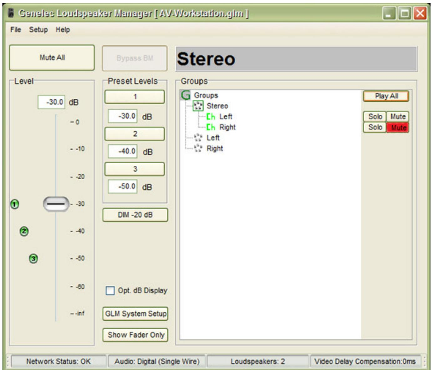
In der rechten Hälfte der Bedienoberfläche sind die einzelnen Lautsprecher und definierte Lautsprechergruppen sichtbar. Diese lassen sich auch einzeln auf Solo schalten bzw. individuell stummschalten.
