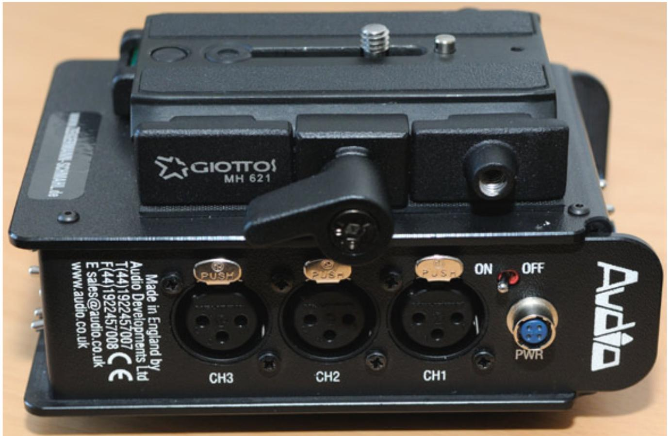
Auf der linken Seite befinden sich die drei XLR-Eingänge, der Hirose-Anschluss für eine externe Stromversorgung sowie ein On/Off-Schalter.
