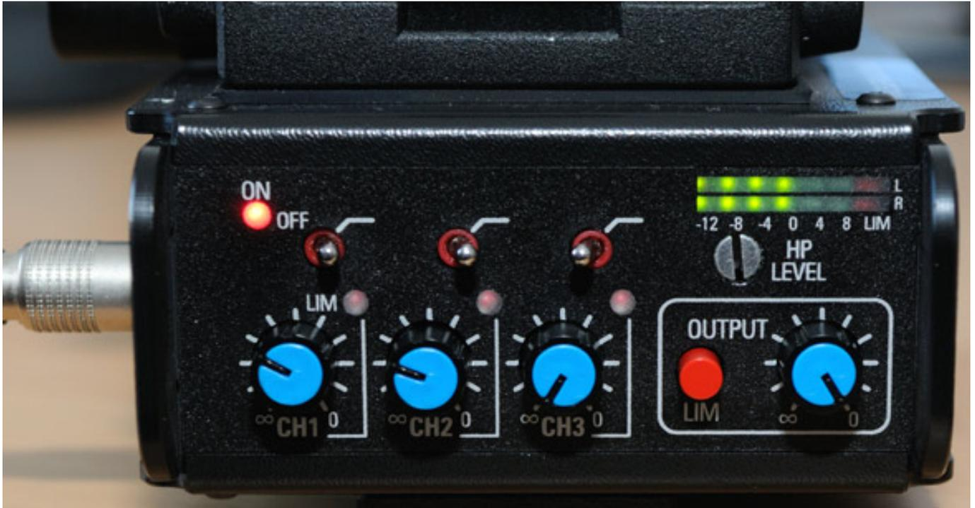
Die Vorverstärker haben eine individuelle Regelung. Ein Hochpassfilter ist pro Kanal zuschaltbar. Die LIM-LED leuchtet bei Eingreifen des Limiters auf. Die Limiter sind nicht abschaltbar, also permanent hinter den Vorverstärkern aktiv.
