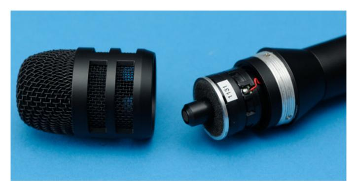
Besonders auffällig ist der lange Handgriff, der auf die Bedürfnisse im Reportageeinsatz abgestimmt ist. Die Länge des Mikrofons beträgt 241 mm. Das Mikrofongehäuse ist komplett aus Metall gefertigt. Der Schutzkorb (40 mm Durchmesser) lässt sich abschrauben und so auch leicht austauschen. Das Gewicht der Mikrofone beträgt 275 Gramm. Die Mikrofonkapsel ist intern mit einem Windschutz aus Schaumstoff versehen.
