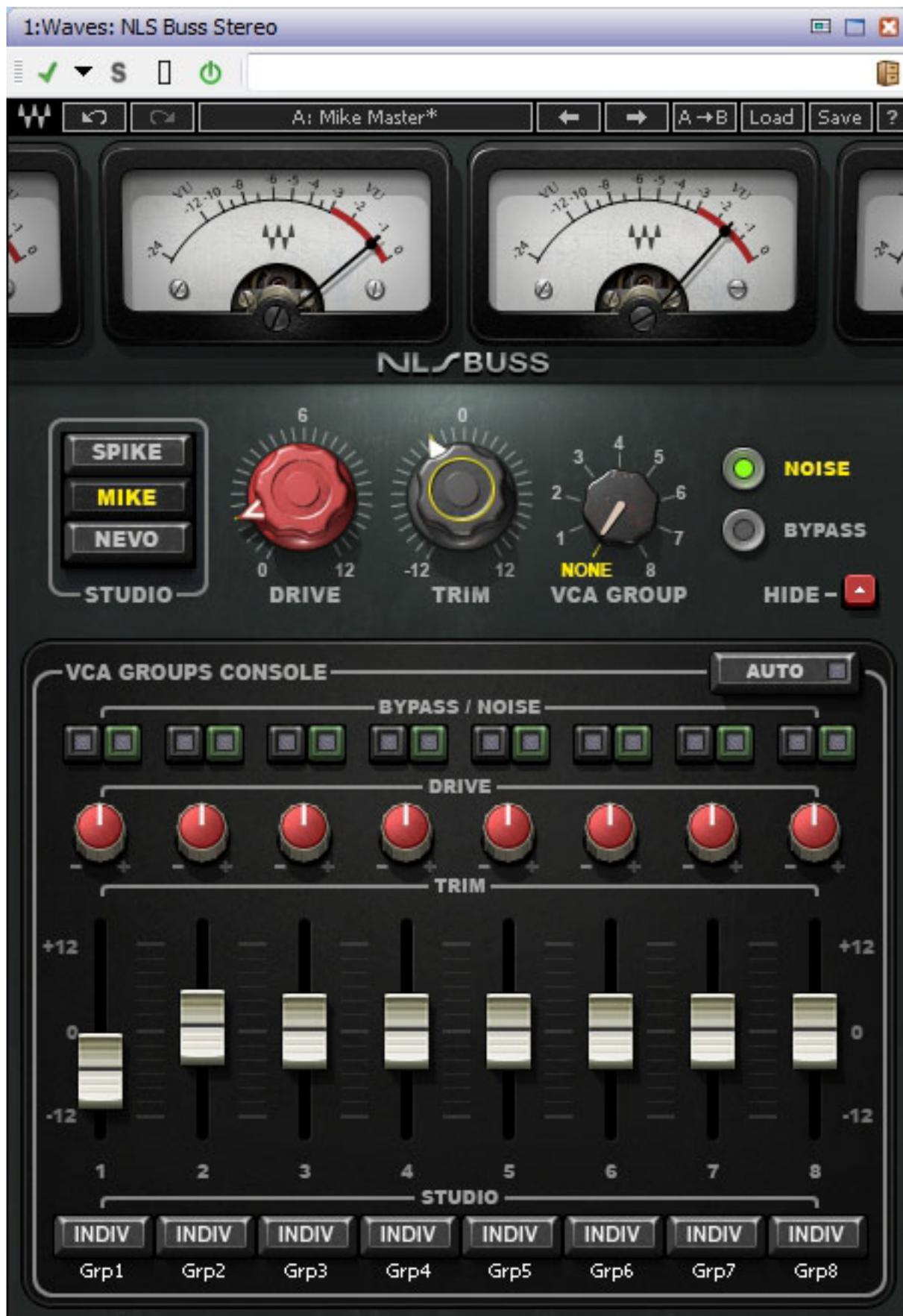
Im NLS Buss Plug-In findet man prinzipiell im oberen Bereich die gleichen Regler wie beim Channel Plug-In. Mit dem Regler Trim kann man eine Pegelanpassung der Summierstufe um +/- 12 dB einstellen. Eine Aktivierung von NOISE und BYPASS kann für jede Gruppe individuell erfolgen oder eben über die Stellung NONE des VCA GROUP Drehschalters global. Die Einstellung erfolgt dann über die beiden Taster neben dem VCA Group Drehschalter.
