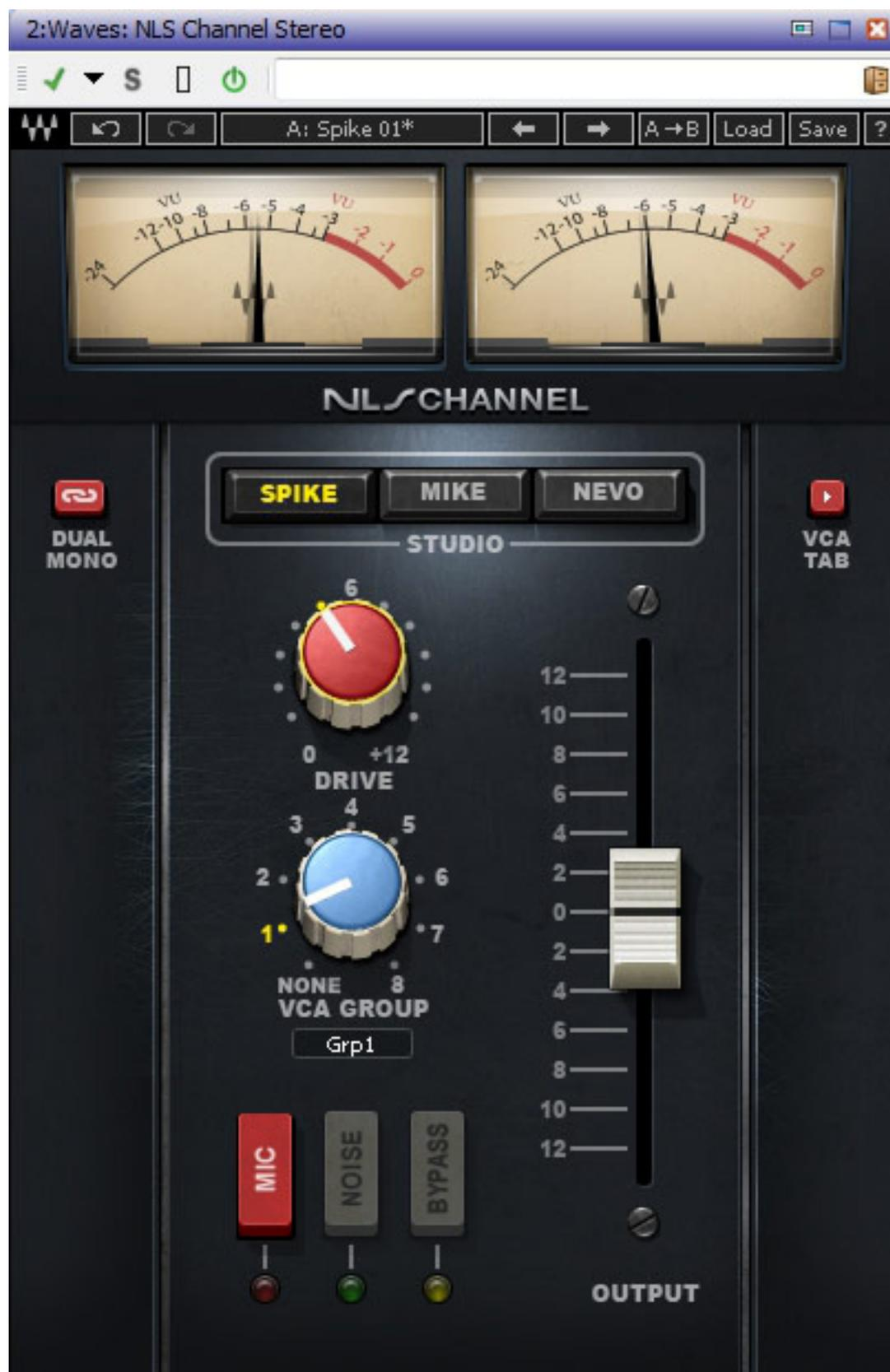
Über den Regler MIC (siehe Abbildung oben) kann der Headroom auf einen Umfang entsprechend Kanälen mit Mikrofonverstärker umgeschaltet werden. Das Plug-In
