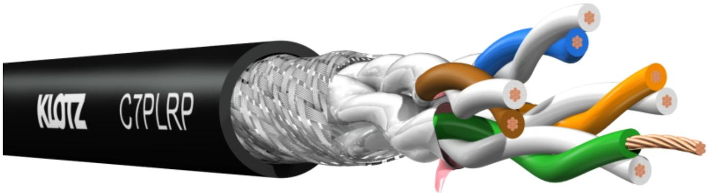
Das neu entwickelte, flexible Netzkabel C7PLRP ermöglicht nun Übertragungslängen bis zu 100m und eignet sich somit hervorragend für mobile Anwendungen, die bis vor kurzem noch typischen Installationskabeln vorbehalten waren. Durch seinen aufwendigen und robusten Aufbau CAT7 - S/FTP - AWG23/7 - 600 MHz mit durchgängigem Außengeflechtschirm und foliengeschirmten Adernpaaren ist dieses KLOTZ Mobilkabel die richtige Wahl, wenn hohe Zuverlässigkeit und schnelle Datenübertragung erforderlich sind.
