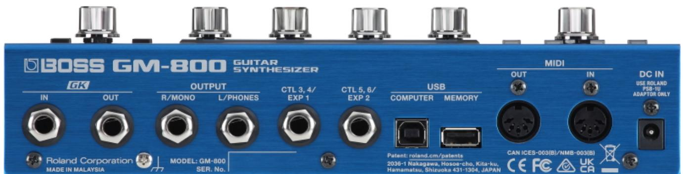
In der BOSS Tone Studio Software für den GM-800 können Anwender via USB Szenen auf ihrem Computer bis ins Detail anpassen. Darüber hinaus lassen sich GM-800 Sounds als Audiospuren in einer DAW aufnehmen sowie softwarebasierte Instrumente und Hardware-Soundmodule über die Guitar-to-MIDI-Funktion spielen.
