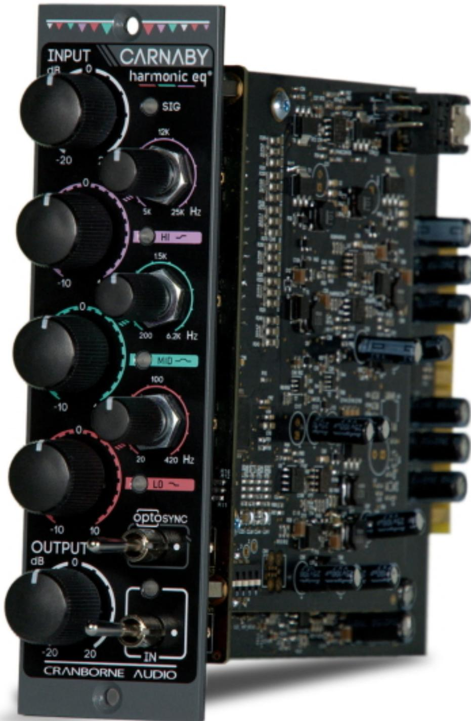
Carnaby 500 ist ein parametrischer 3-Band-EQ für das 500er-Format mit einem einzigartigen und revolutionären EQ-Konzept, das von Cranborne Audio entwickelt wurde. Carnaby 500 ist der weltweit erste Harmonic EQ - ein analoger EQ, der die harmonische Sättigung nutzt, um Frequenzanteile zu verstärken und abzusenken. Er bearbeitet Quellen, Stems und Mischungen mit echter analoger harmonischer
