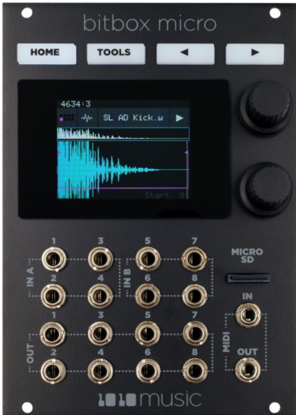
Der beliebte, kompakte Eurorack-Sampler ist jetzt noch stilvoller mit seinem edlen schwarzen Finish. Die bitbox micro ist der perfekte Eurorack-Sampler für kleinere Racks. Auf nur 18 HP ist ein Touchscreen-basierter Sampler mit bis zu 8 Sample-Pads untergebracht. Samples können direkt aufgenommen oder von einer Micro-SD-Karte geladen werden. Die Samples können über CV oder MIDI getriggert, mit
