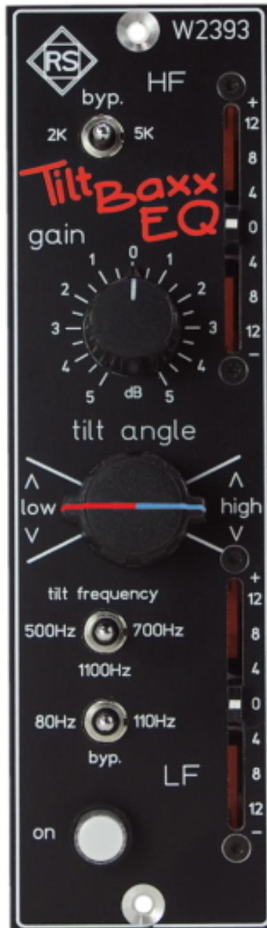
Der TiltBaxxEQ W2393 im 500 Format bietet vielseitige Möglichkeiten zur tonalen Beeinflussung jeglicher Audiosignale mit wenigen Klangstellern. Ein TiltEQ bestimmt mittels eines Niveau-Filters das Klangspektrum um eine vorgewählte Mittenfrequenz und ein Baxandall-Klangregler bestimmt die Verteilung der tiefen und hohen Frequenzen. Zusammen ergeben diese Filter ein mächtiges Werkzeug zur schnellen und wirkungsvollen Beeinflussung des Klangspektrums.
