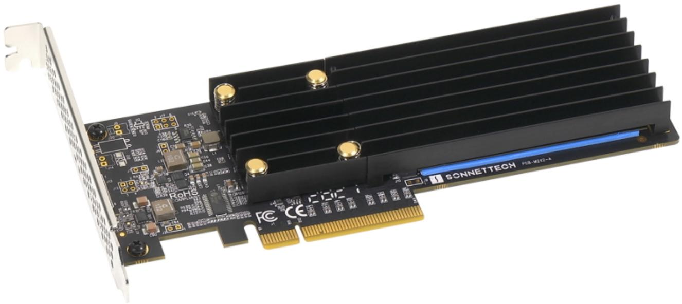
Mit der M.2 2x4 Low-Profile PCIe Karte erweitert Sonnet sein umfangreiches Angebot an Hochleistungs-Speicheradapterkarten, mit denen mehrere SSDs am PCIe-Slot eines Computers oder Thunderbolt-Erweiterungssystems genutzt werden können. Die Low-Profile PCIe 3.0-Karte mit halber Länge bietet zwei Steckplätze für NVMe PCIe SSDs mit M.2-Formfaktor.
