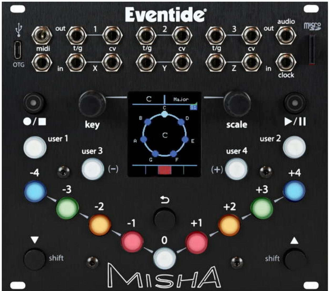
Eventide stellt Misha vor, ein innovatives 28-PS-Eurorack-Instrument/Sequencer, das einen einzigartigen, intervallbasierten Ansatz zum Spielen und Erzeugen von Melodien verwendet. Mit Misha können Sie Klänge über MIDI, Steuerspannung (mit drei unabhängigen Gate/CV-Paaren) oder die Ausgabe von Wellenformen über den Audioausgang erzeugen. Steuern und spielen Sie Misha über ein MIDI-Keyboard oder eine Standard-USB-QWERTY-Tastatur
