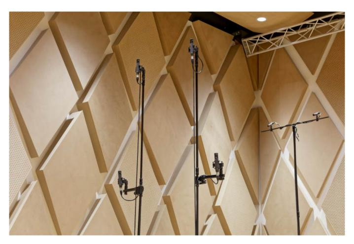
Karl Tessmar ist ein ausgewiesener Liebhaber innovativer 3D-Klangwelten, weshalb bei Aufnahmen ergänzend zur konventionellen Mikrofonierung fast immer auch ein für dreidimensionale Recordings geeignetes Mic-Setup aufgebaut wird. Das Mikrofon-Array mit vier Sennheiser MKH 800 TWIN Studio-Kondensatormikrofonen hört auf die Bezeichnung Square und wurde von Diplom-Tonmeister Gregor Zielinsky konzipiert.
