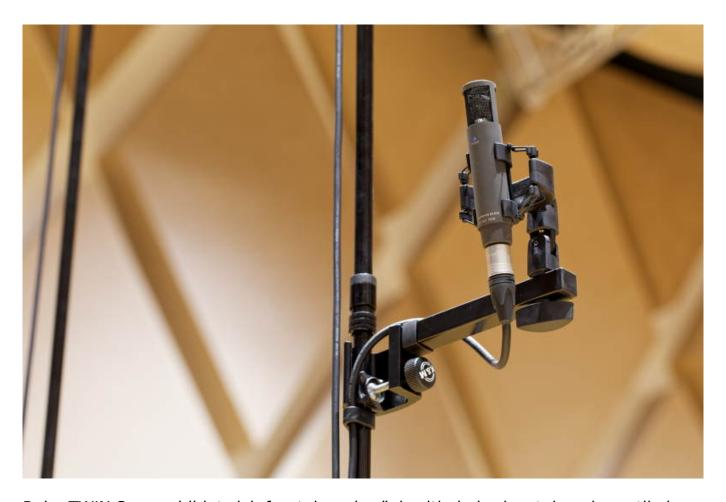
Beim TWIN Square bildet sich frontal sowie rückseitig in horizontaler wie vertikaler Ebene jeweils ein laufzeitbasiertes Stereopaar aus. Die Klangergebnisse überzeugen und können durchaus mit den unter Tonmeistern bekannten Cube-Array-Konzepten mithalten – bei einer deutlich einfacheren Handhabung sowie geringeren Anschaffungskosten im Vergleich zu Cubes mit acht oder neun in Form eines Würfels positionierten Mikrofonen.
