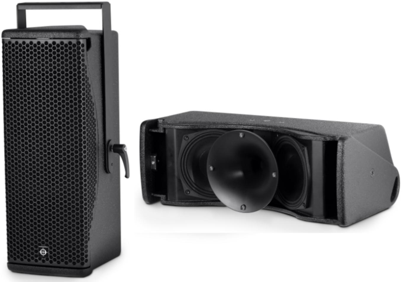
Ultrakompaktes Design, überragende Leistung: Mit der nur 518 mm x 190 mm x 273 mm großen und 9,2 kg leichten HOPS7-Pro präsentiert CODA Audio das neueste Modell der HOPS-Lautsprecherreihe. Bestückt mit einem neuentwickelten 1,75-Zoll-Neodym-Ringmembran-Treiber sowie zwei 6,5 Zoll-Neodym-Konus-Lautsprechern liefert der vielseitige 2-Wege-Full-Range-Lautsprecher eine Belastbarkeit von eindrucksvollen 1000 W (AES) - und das bei extrem geringen Verzerrungen.
