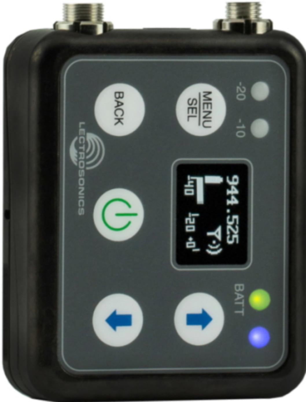
Der DSSM bietet ein umfangreiches Funktions- und Leistungsspektrum in einem außergewöhnlich kompakten Gehäuse, das mit allen aktuellen Lectrosonics Digital-Receivern kompatibel ist, einschließlich DSQD, DCR822, DSR, DSR4, M2Ra und DCHR. Der DSSM verfügt über eine speziell entwickelte, hocheffiziente Schaltung für eine längere Betriebszeit mit der wiederaufladbaren LB-50-Batterie. Als HF-Leistung
