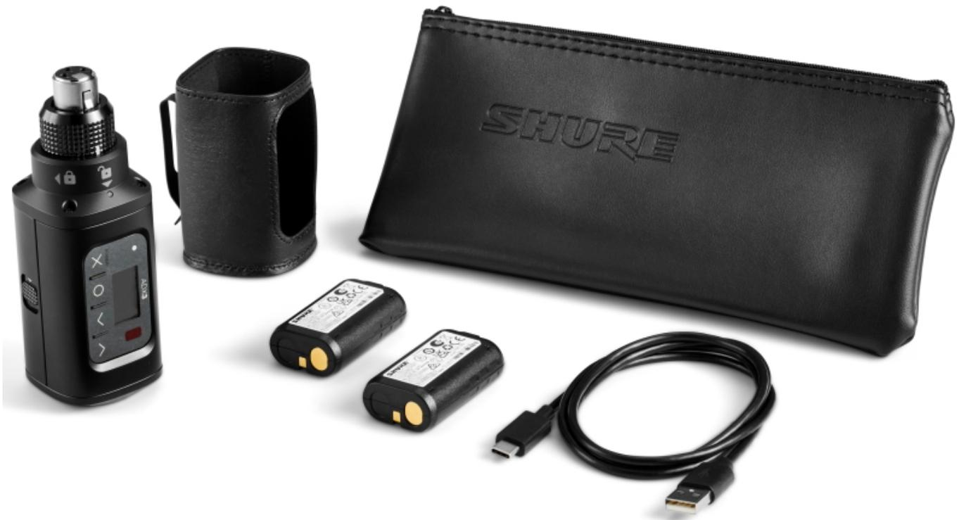
Im Lieferumfang des ADX3 sind zwei SB900 Lithium-Ionen-Akkus enthalten. Jeder dieser Akkus ermöglicht bis zu sechseinhalb Stunden ununterbrochenen Betrieb und bietet eine präzise Lademessung ohne Memory-Effekt. Der SB900 kann über einen USB-C-Anschluss geladen werden. Alternativ kann der Sender extern über USB-C oder mit zwei AA-Batterien mit Strom versorgt werden.
