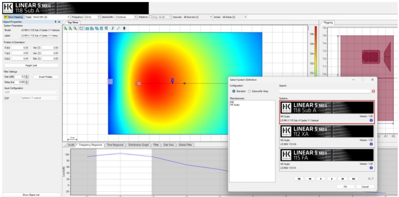
Für die Lautsprecher der smarten und leistungsstarken LINEAR 5 MK II-Serie stehen jetzt Simulationsdaten im GLL-Format für EASE und EASE FOCUS 3 zur Verfügung. Die Software EASE von AFMG ist der weltweit etablierte Standard für Elektro- und Raumakustiksimulation. Akustiker, Planer und Installateure können mit EASE hochpräzise Simulationen beliebiger Räume erstellen.
