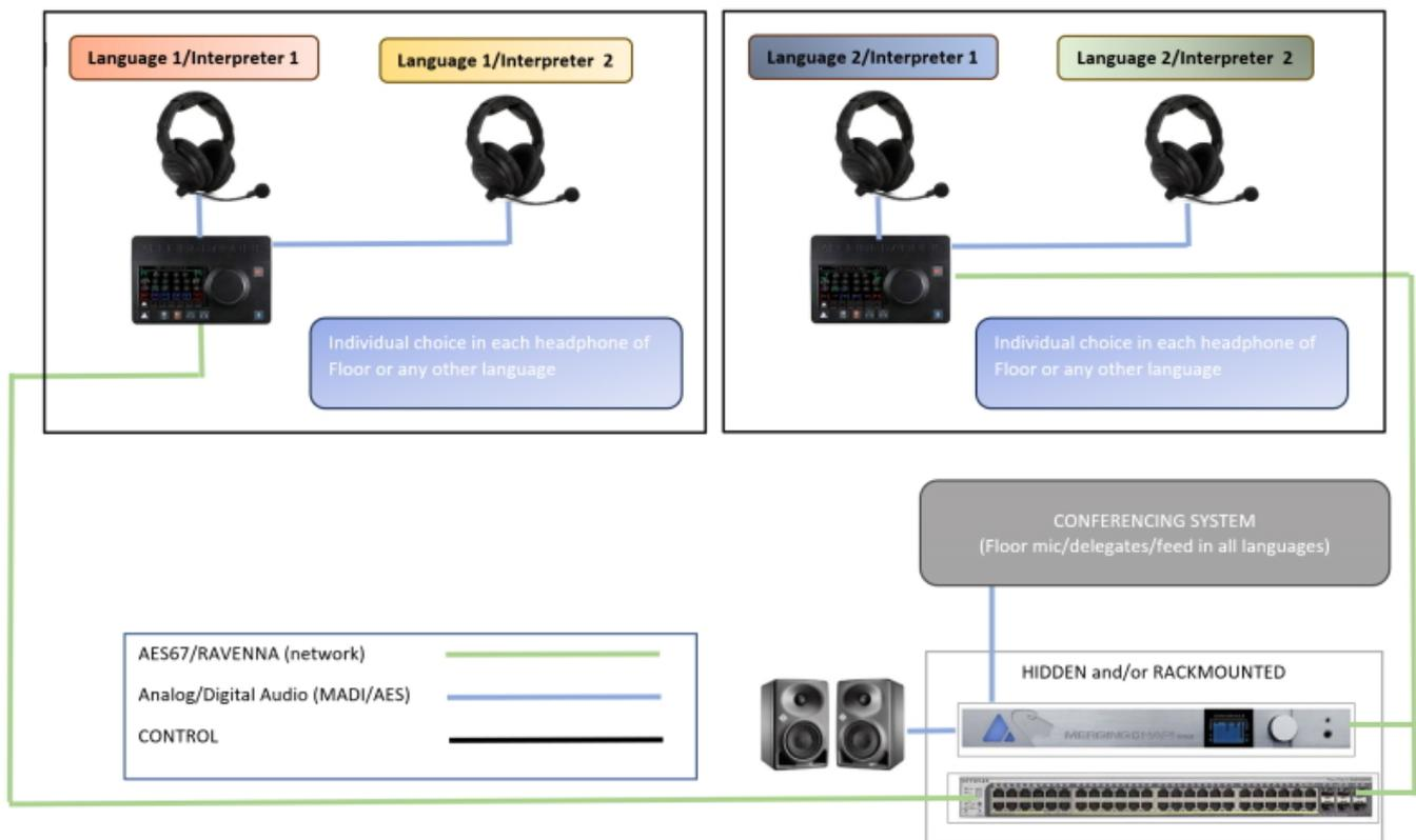
Alle Anubis sind netzwerkfähig (AES67/ST2110), sodass sämtliche Audiostreams in einem beliebigen Anubis zur Verfügung gestellt werden können. Ein Hapi Mk II (AD/DA-, Madi-, AES/EBU-Wandler) dient als Ein-/Ausgangspunkt mit allen Standardformaten für den Anschluss an das Pult, die Lautsprecheranlage oder ein Konferenzsystem. Ein wesentlicher Vorteil dieser Dolmetscherlösung besteht darin, dass sie über VPN und die IP-Adresse der einzelnen Anubis aus der Ferne bedient werden kann.
