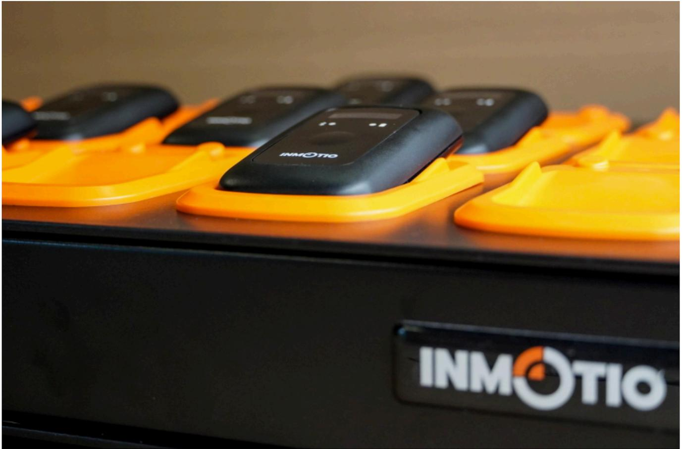
Riedel hat die proprietäre LPM-Technologie (Local Position Measurement) des niederländischen Sportanalyse-Experten Inmotio erworben. LPM ist ein auf Radartechnologie basierendes System, das die Position von Spielern und Objekten mit einer Genauigkeit von +/- 3 cm, in Hochfrequenz (1.000 Hz) und in Echtzeit misst.
