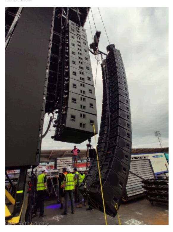
Als Delays werden die kleineren KSL8 in Arrays aus 16 Lautsprechern pro Seite eingesetzt. Alle Arrays werden im Compression Mode geflogen, aber kleinere KSL8
