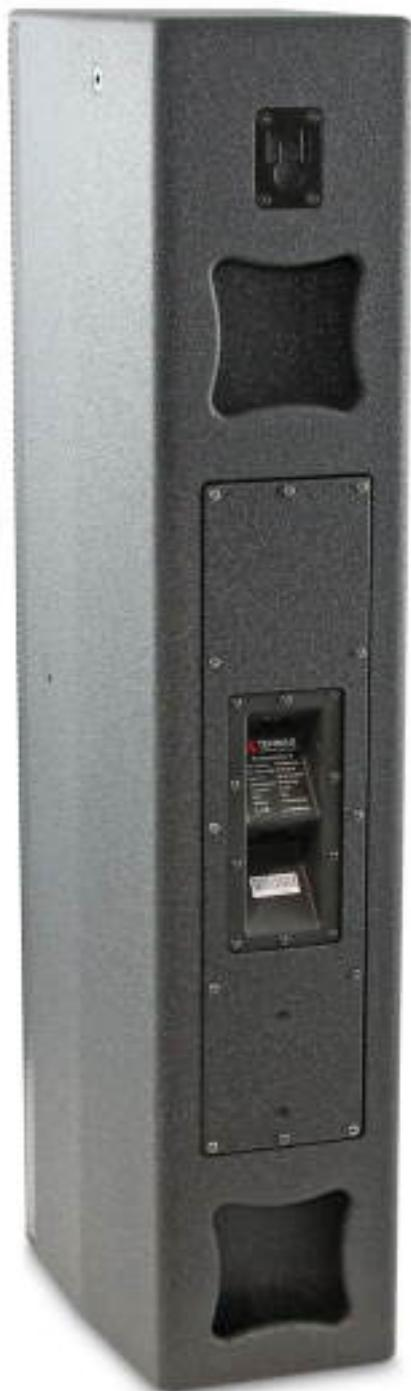
Wie die anderen Mitglieder der TENNAX-Familie ist auch der Powerstick-6 aus hochwertigem Birkenmultiplex gefertigt, CNC-gefräst, genutet, wasserfest verleimt, verschraubt und mit wetterfesten Polyurea beschichtet. Außerdem bietet er verschiedene M10-Gewindepunkte, U- und C-Schwenkbügel, Wand- und Masthalterungen sowie einen integrierten Sicherungspunkt für die vorgeschriebene Sekundärsicherung.
