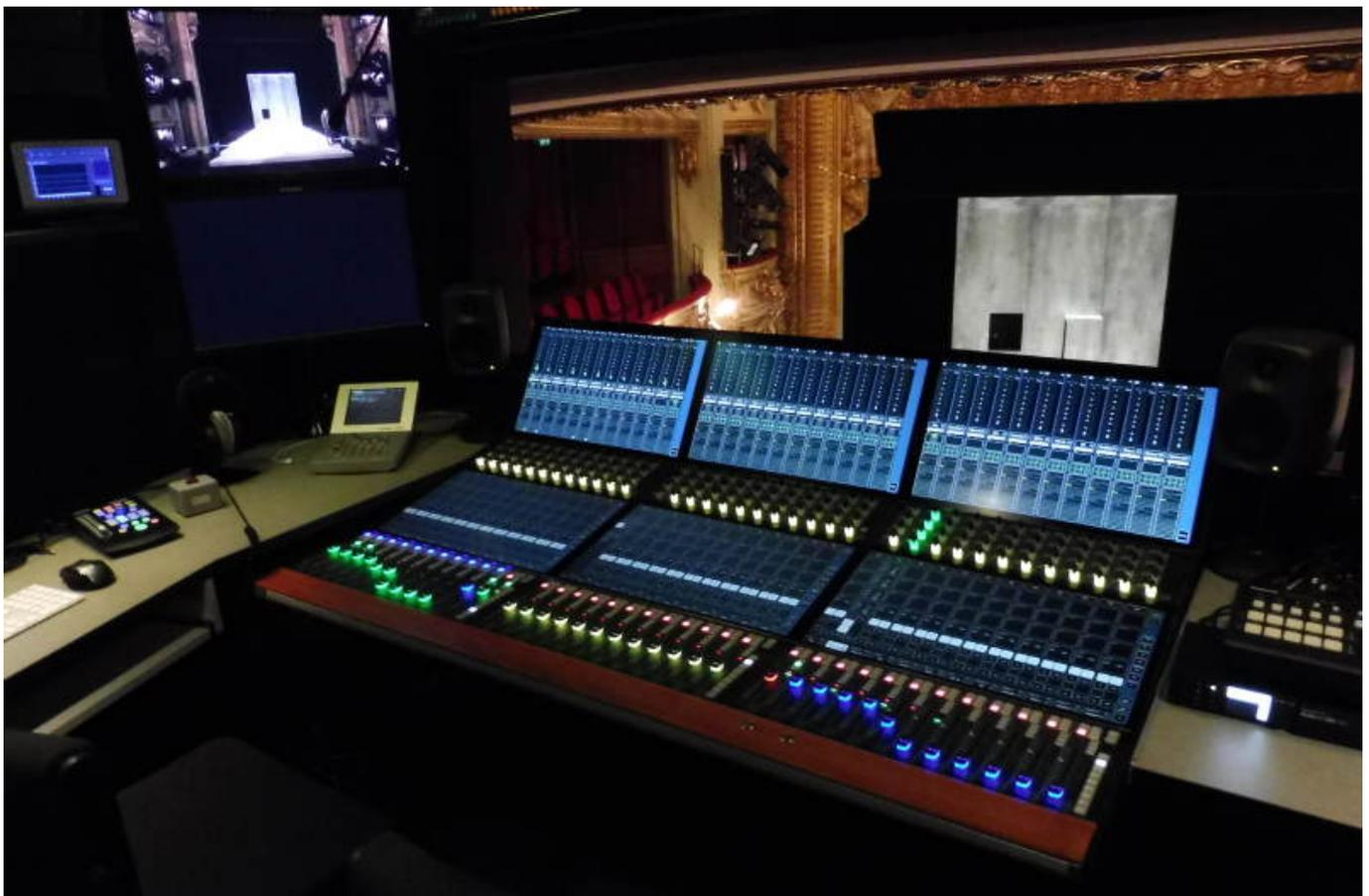
Das gesamte AVATUS System wird mit maximaler Flexibilität genutzt. Jedes der drei Pulte arbeitet für sich autark z.B. als Monitorpult oder FOH und ist bei jedem Einsatz User-programmiert. Das Pult in der Tonregie kommt bei Produktionen wie Opern oder Schauspiel ohne FOH zum Einsatz. Das mittlere 24 Fader Mobilteil kommt für kleinere Produktionen zum Einsatz und das kleine 12 Fader Pult bei Proben. Für Live-
