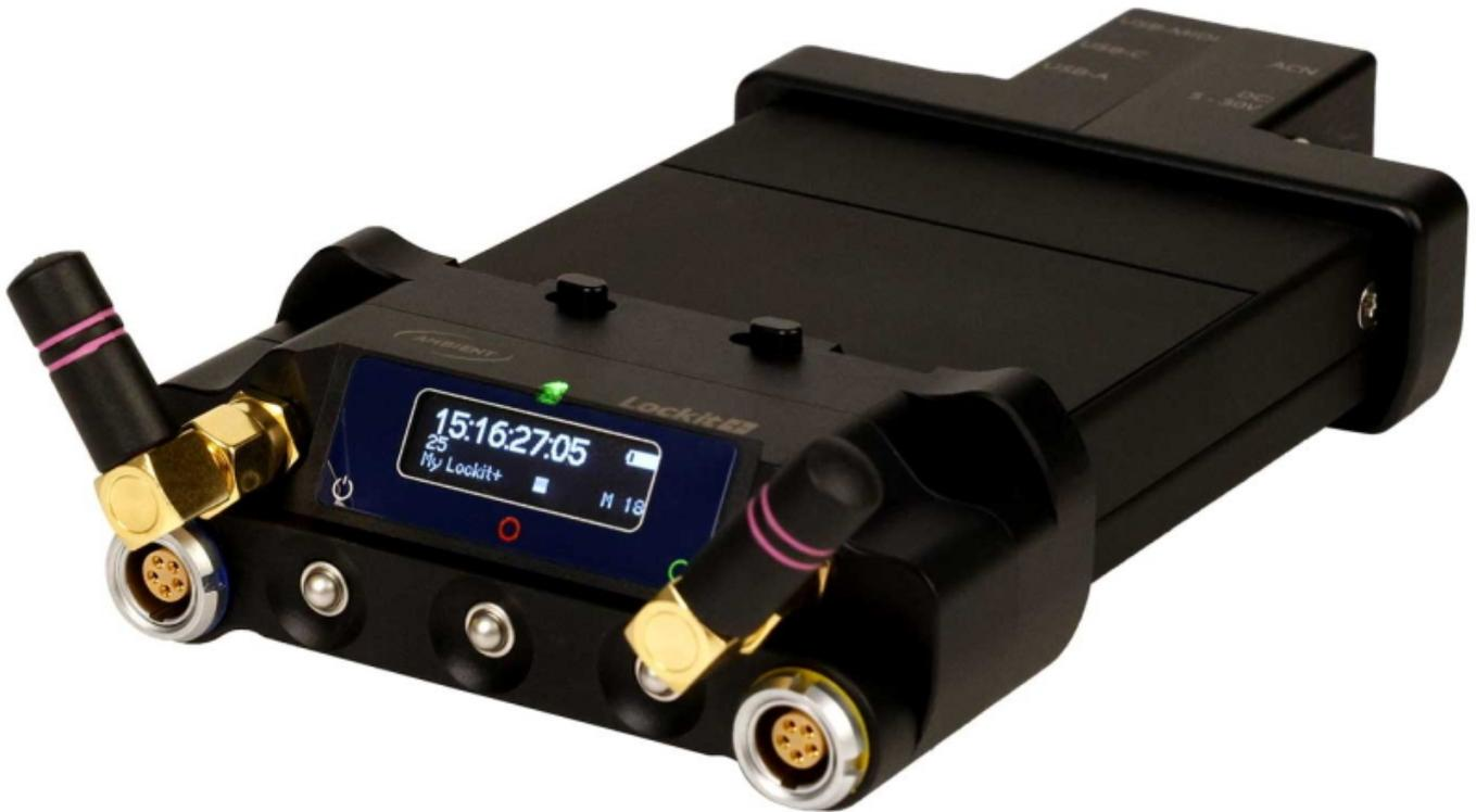
Der Lockit+ vereint die hochpräzise Ambient Lockit Timecode- und Sync-Technologie mit fortschrittlichen Optionen für die Verwaltung von Metadaten, um den Workflow zwischen Set und Schnitt zu verbessern. Er ist der Nachfolger sowohl des MasterLockit als auch des MasterLockitPlus. Viele Anregungen der Benutzer sind in die Weiterentwicklung eingeflossen, um den Lockit+ zum würdigen Flaggschiff der Lockit-Familie zu machen.
