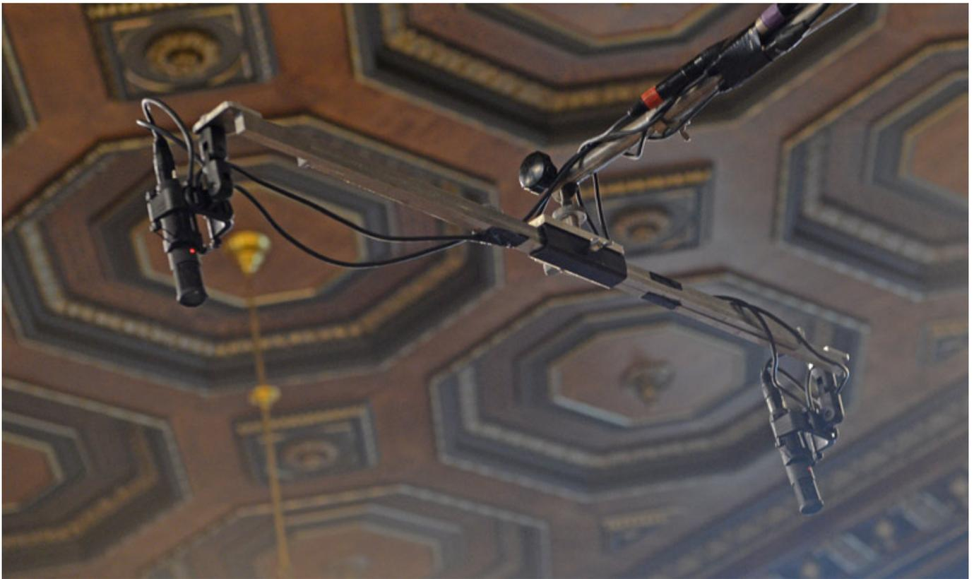
Es wurde auch ein klassisches Hauptmikrofon mit zwei MKH 800 Twin (s. Abb. oben) sowie zwei Raummikrofone mit MKH 8040 aufgenommen - insgesamt also über 80 Mikrofone und wegen der Twins über 110 Audiokanäle. Die Hauptmikrofone hatten primär die Aufgabe dem Tonmeister einen klanglichen Gesamteindruck des Orchesters zu vermitteln.
