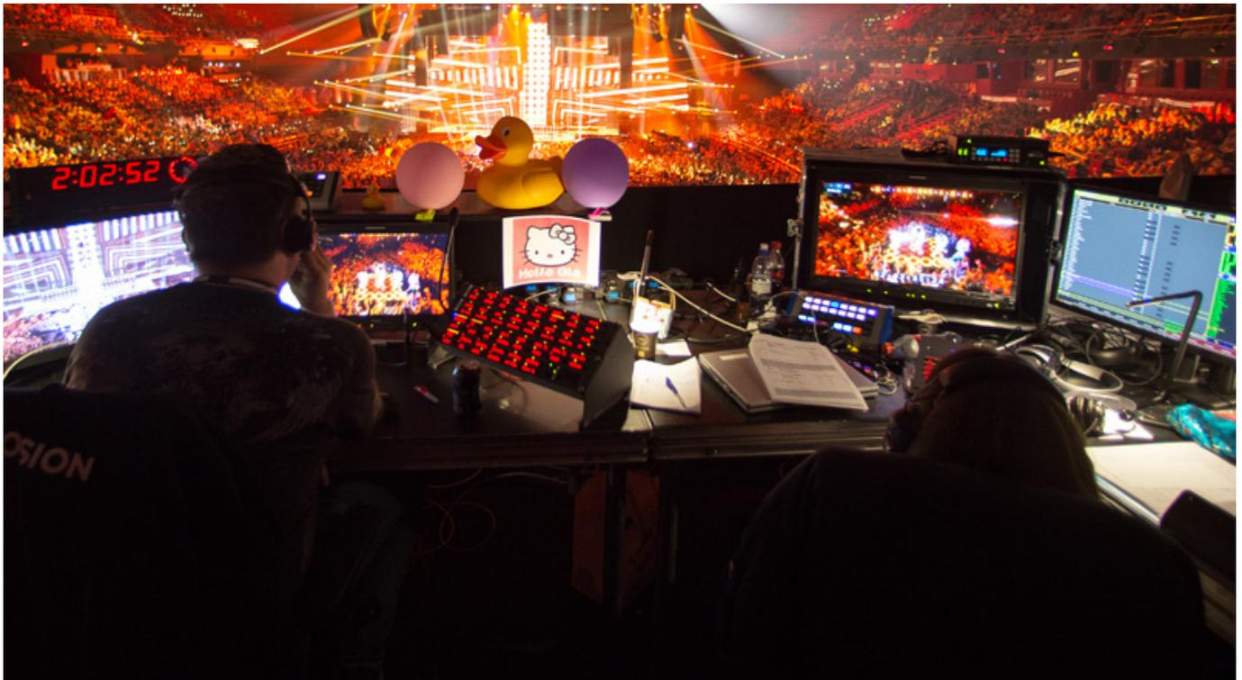
Die Kommentatorenkabinen waren auf zwei Etagen verteilt. Der NDR im Auftrag der ARD war mit zwei Kabinen vertreten und zwar eine für Radio und eine Doppelkabine für TV. Man setzte beim NDR drei ISDN-Codecs mit MPEG-Codierung ein und zwar für On-Air, Backup-On-Air und Kommando-Leitung.
