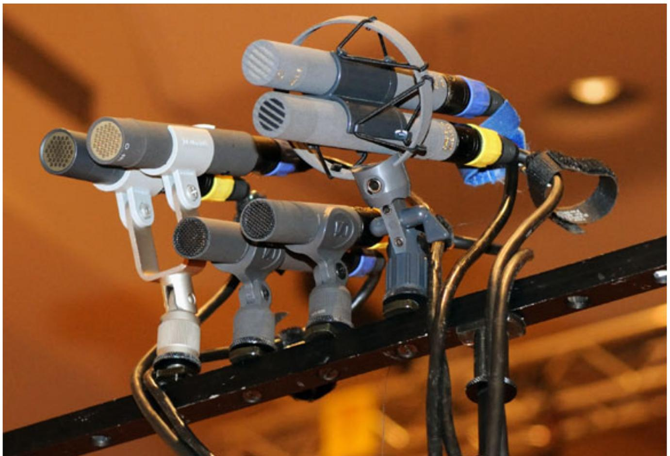
Hier (Foto oberhalb) eine der beiden Mikrofonschienen für das Hauptmikrofon. Aufgebaut wurden von links nach rechts: Neumann KM 130, Neumann KM 183D, Sennheiser MZD 8000 + MKHC 8020 (Digital), Sennheiser MKH 8020, Schoeps MK 2S + CMD2U (digital, oben), Schoeps MK 2S (analog, unten).
