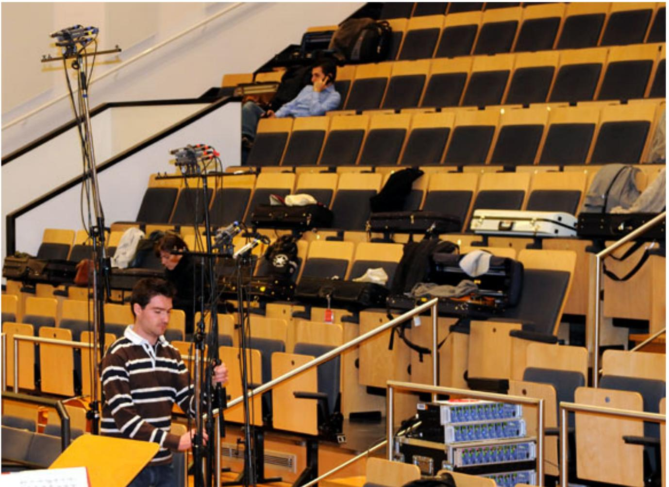
Hier baut Frank Albiker gerade die Mikrofone für den Test mit dem Orchester auf (Foto oben). Rechts sind die beiden AES42-Interfaces DMC-842, welche von RME bereitgestellt wurden, und darunter die beiden Micstasy Preamps/Wandler von RME aufgebaut. Man sieht, dass man die Kabellängen bewusst kurz gehalten hat.
