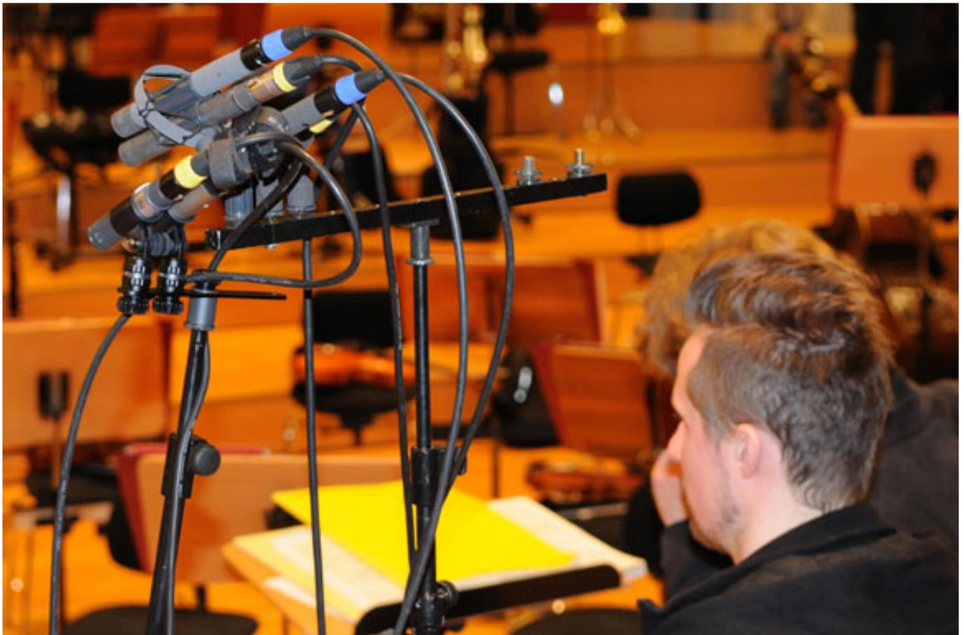
Auch für die Stützmikrofone wurden drei Vergleichs-Sets aufgebaut und zwar für erste Violine, Celli, Oboen und für Kontrabass ein TLM 103D. Im Bild (oberhalb) sieht man die Stütze für die ersten Violinen.
