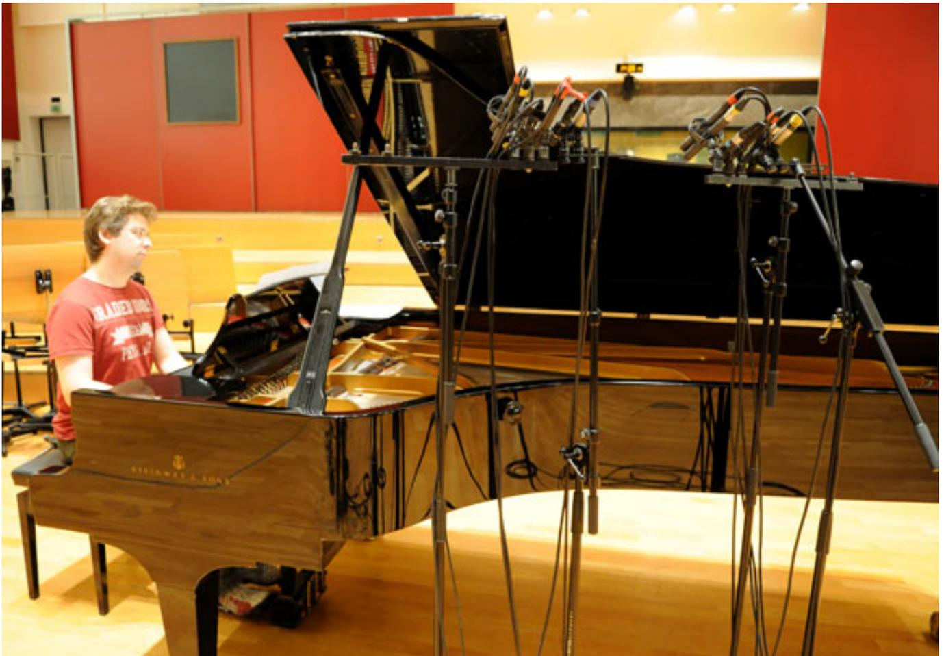
Das Hauptmikrofon war wie bei den Orchesteraufnahmen und das Spot-Mikrofon war wie folgt bestückt (von links nach rechts): Neumann KM 143D, Neumann KM 143 (analog), Sennheiser MZD 8000 + MKHC 8040, Sennheiser MKH 8040, Schoeps MK 22 + CMD2U (digital, oben), Schoeps MK 22 (analog, unten).
