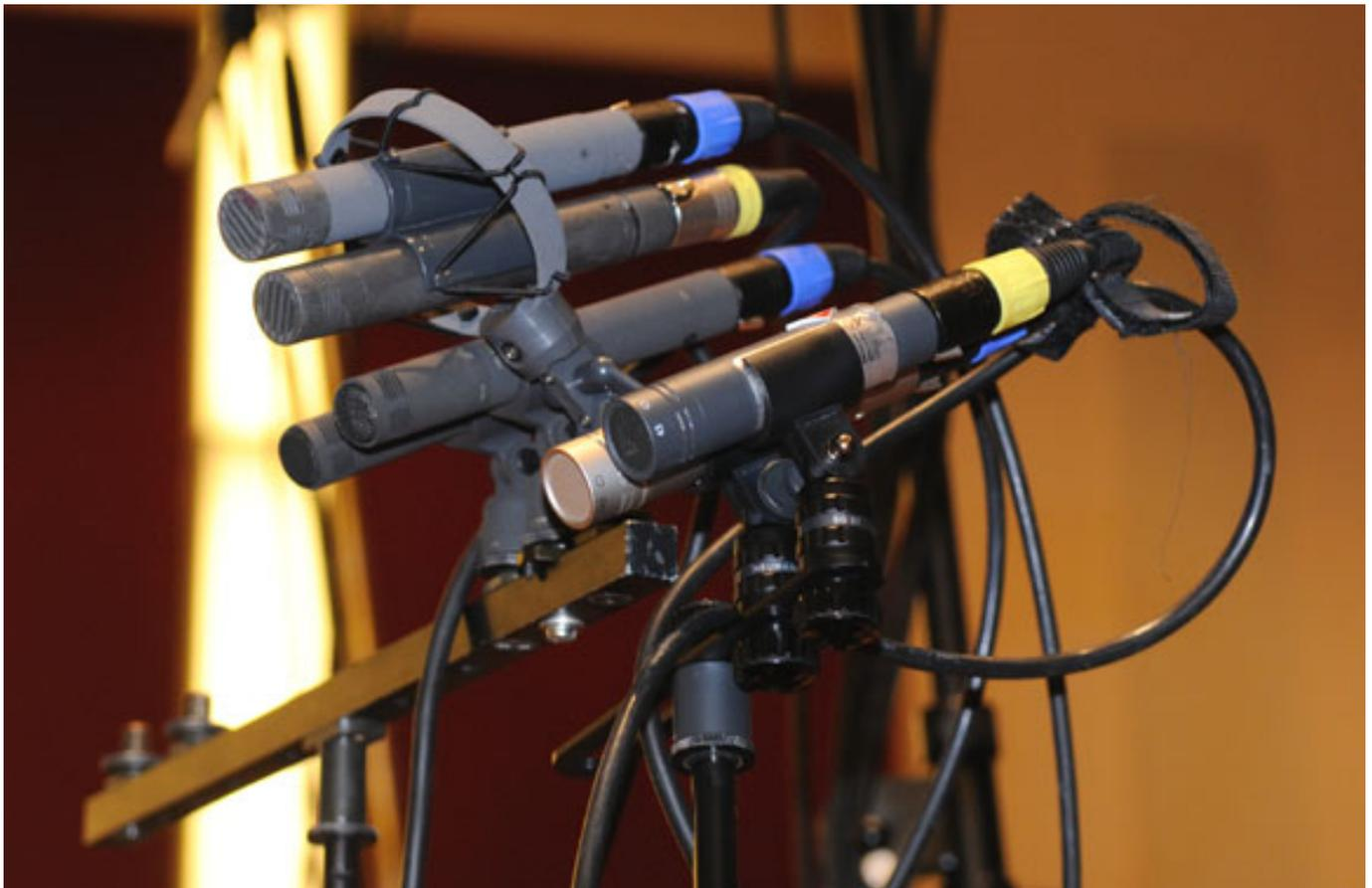
Hier von links nach rechts: Sennheiser MKH 8040, Sennheiser MZD 8000 + MKHC 8040, Schoeps MK 22 + CMD2U (digital, oben), Schoeps MK 22 (analog, unten), Neumann KM 143D (digital), Neumann KM 143 (analog).
