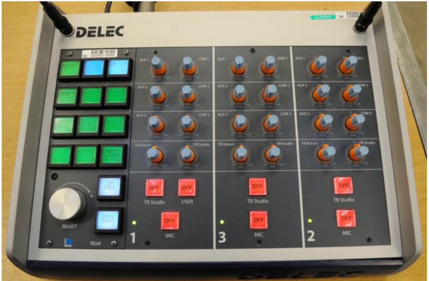
Das Kommentatorensystem für den Ü-Wagenbetrieb mit eingebauter Telex-Gegensprechkassette von Hugentobler (links) lässt sich auch mit 12-Volt-Versorgungsspannung betreiben.
