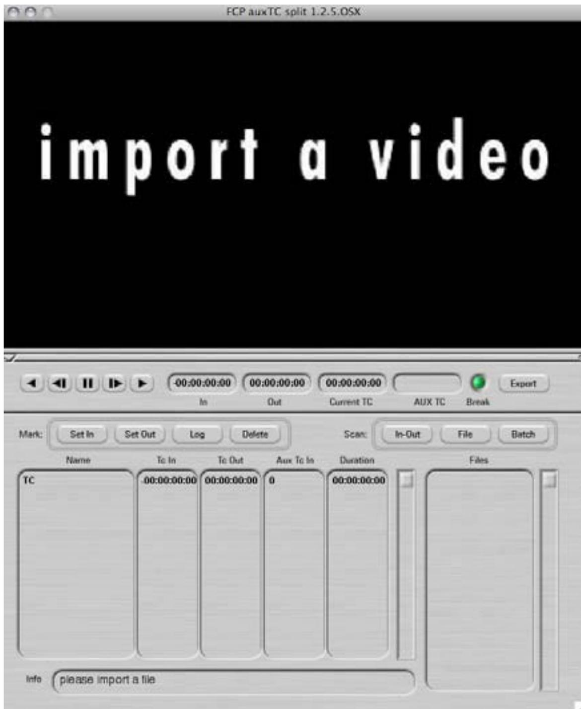
Um nun den als Audio-Signal aufgezeichneten Timcode (LTC aus dem Clockit) jedes Clips als AUX TC verfügbar zu machen, musste dieser ausgelesen werden. Leider verfügt FCP bisher über kein eigenes Tool dafür. Hier kam das Programm „FCP auxTC reader“ von VideoToolShed zum Einsatz. In unserem Workflow haben wir das Videomaterial in Blöcke von max. 30 Clips unterteilt, die wir in FCP importiert haben und dann als XML-File exportiert haben.
