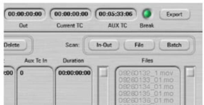
Bei unseren Test mit Ambient haben wir festgestellt, dass der TC einen Versatz um ein Bild aufweist. Dieser lässt sich im „FCP auxTC reader“ als „Offset 1“ einstellen und somit automatisch korrigieren.
