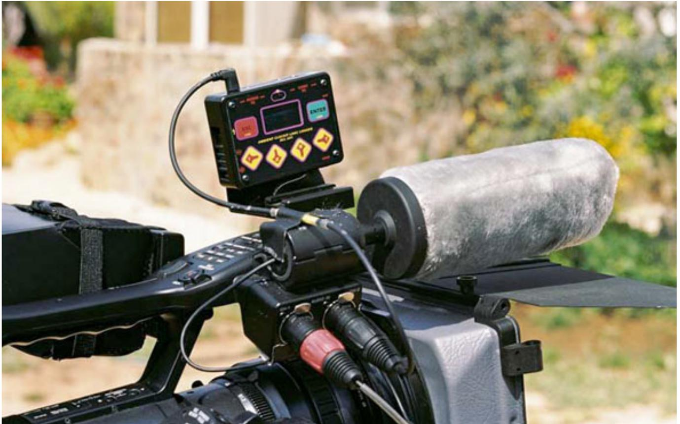
Zur Aufzeichnung des LTC-Signals, welches zuvor mit dem SD 744 T synchronisiert wurde, wird der TC-Out des Clockits auf einen der Audioeingänge, möglichst immer der gleiche (in unserem Fall CH 1) der Kamera gesteckt und an der Kamera auf -20 dB gepegelt. Das Eingangssignal entspricht einem LINE - Signal. Somit befindet sich auf der entsprechenden Audiospur jeder Aufnahme ein LTC-Signal, welches synchron zum TC-Signal der Tonaufnahmen des SD 744 T ist.
